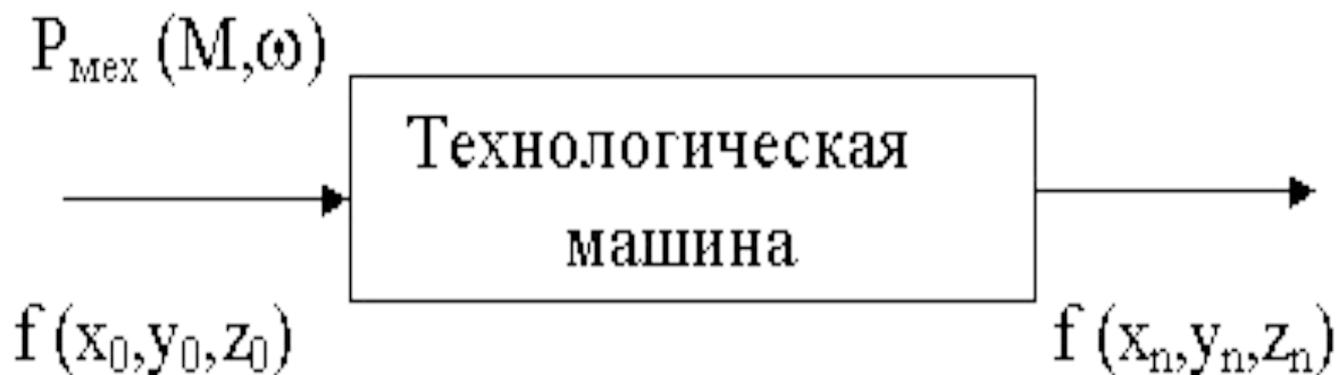
Транспортные (рабочие) машины используют механическую энергию для изменения положения объекта.
