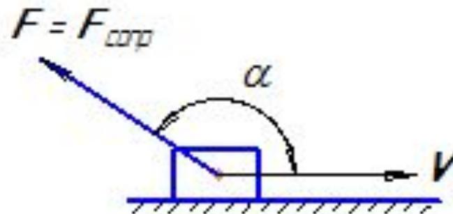
**Силовой расчет сводится к определению неизвестных сил, действующих на звенья механизма.**
