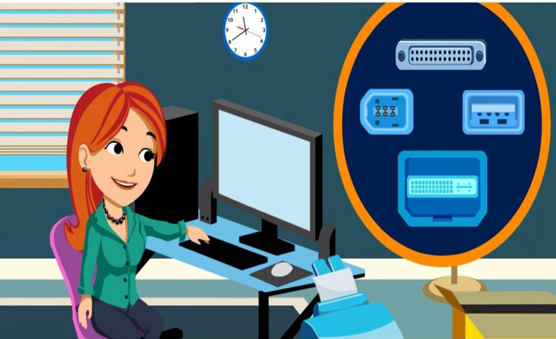
Порты позволяют подключать к компьютеру различные устройства ввода и вывода данных. Чаще всего используются порты USB (универсальная последовательная шина) и Firewire (для быстрых цифровых устройств), сетевой порт (для соединения с Интернетом), а также разъемы для подключения монитора и питания компьютера.
