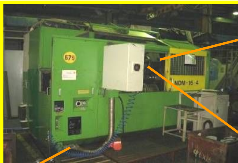
Гибкие кабель-каналы не закрыты кожухом
