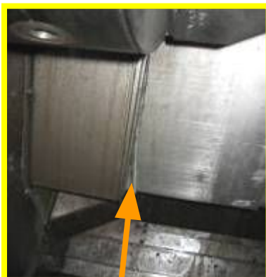
Попадание стружки в телескопические шторы, разбрызгивание СОЖ
