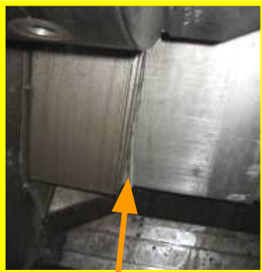
Попадание стружки в телескопические шторы, разбрызгивание СОЖ
