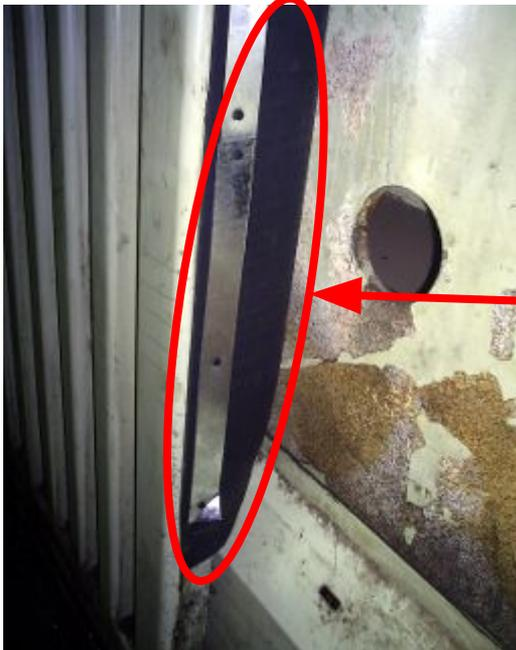
Установлен резиновый уплотнитель позволяющий, **устранить** разлет стружки за пределы станка
