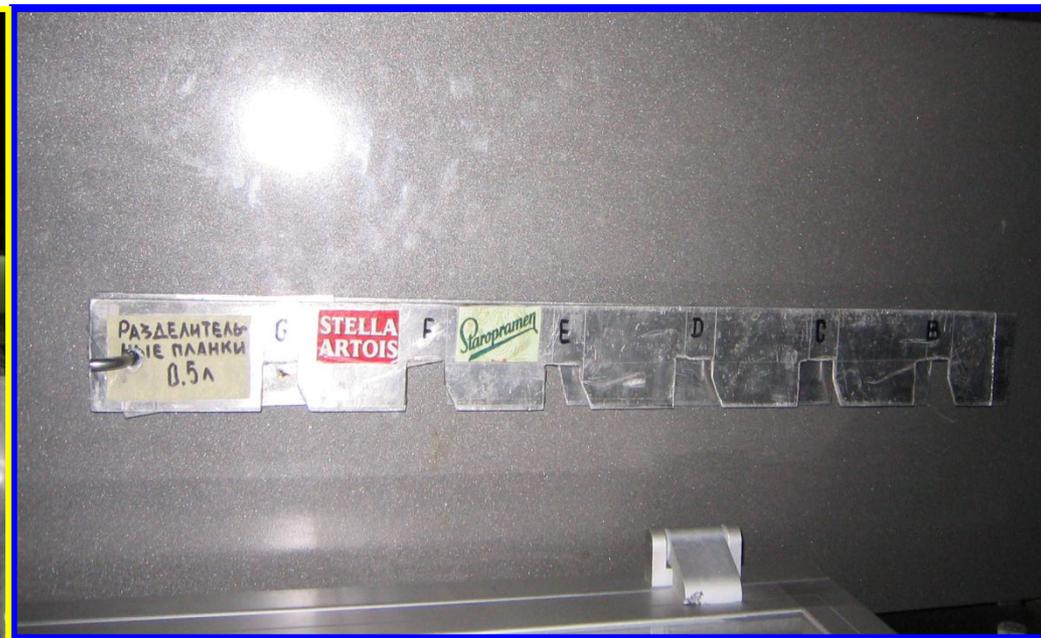
**Для ускорения внутренней переналадки с сорта на сорт на упаковщике «Dimac» предложены металлические шаблоны, изготовленные по размерам и положению установок на хорошо отлаженной машине.**
