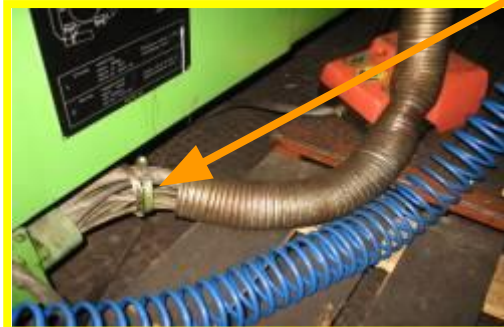
Попадание стружки в телескопические шторы, разбрызгивание СОЖ
