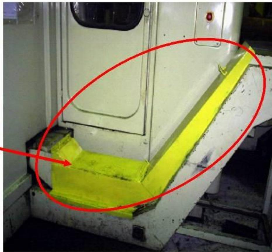
Установлен защитный кожух,
