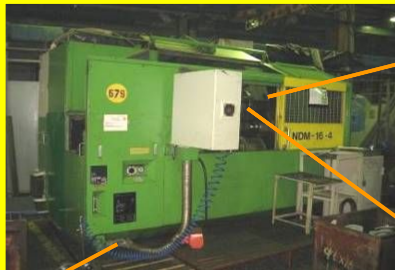
Гибкие кабель-каналы не закрыты кожухом
