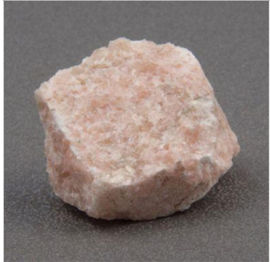
Под действием времени на поверхности образуется корка выветривания
