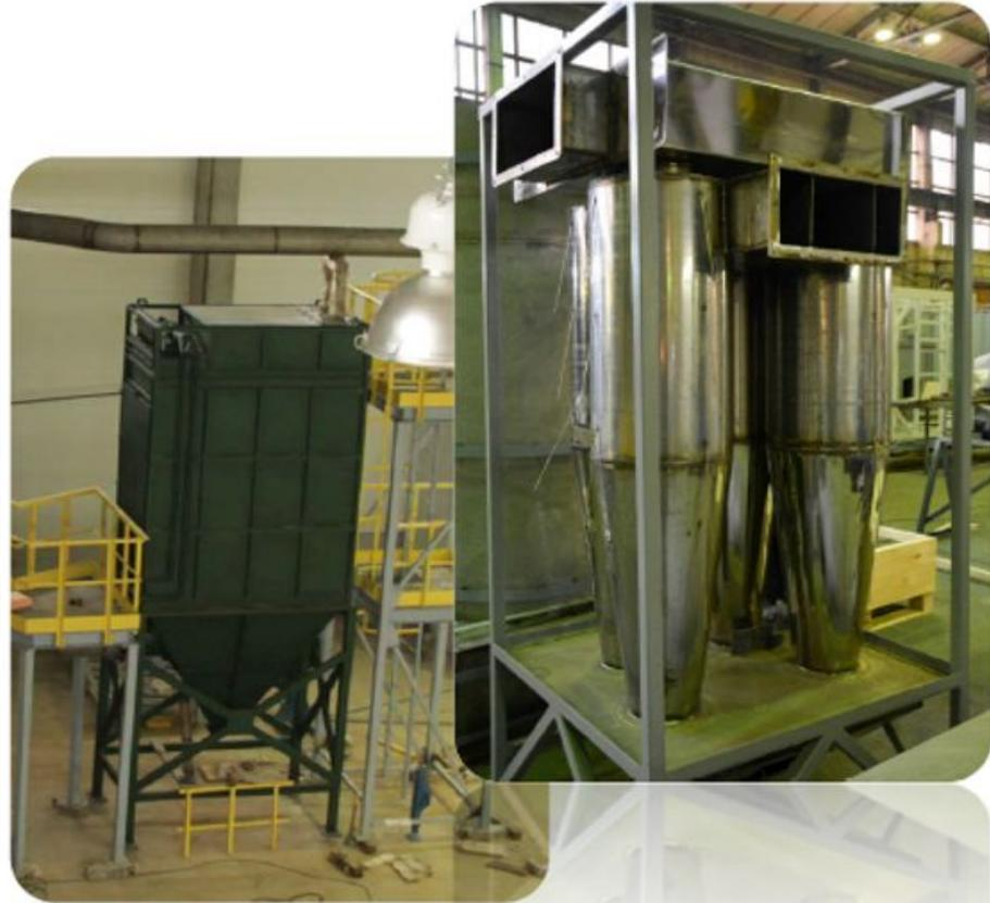
Узел механической очистки газов
