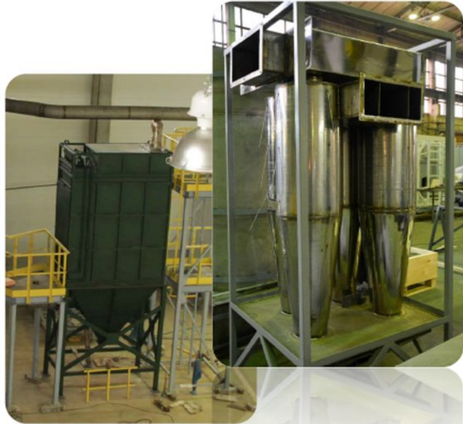
Узел механической очистки газов
