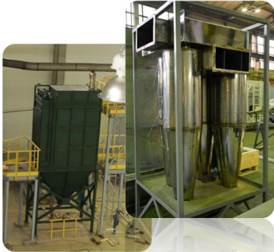
Узел механической очистки газов
