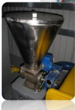
Узел восстановления Узел приготовления и дозирования реагентов
