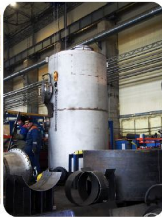
Узел реагентной нейтрализации газов
