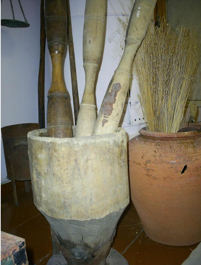
Приспособление для изготовления круп из неочищенных зёрен пшеницы, ячменя, овса. Ступы выдалбливались из дерева. Их высота была 80 см, глубина – 50 см, диаметр – 40 см. деревянный пест изготавливался до 100 см длины при диаметре до 7 см. При толчении в ступе зерно освобождается от оболочки и частично размельчается.
