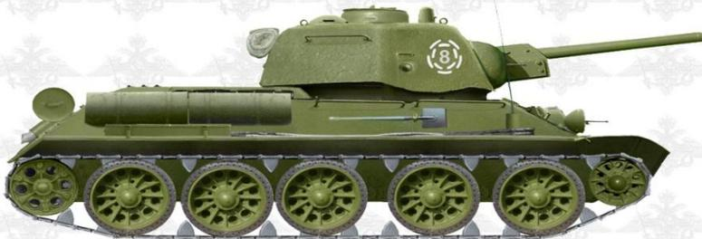
Средний танк Т-34 выпуска 1943 г. со штампованной башней
