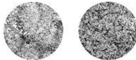
Микроструктура стали 35ГС до и после термической обработки
