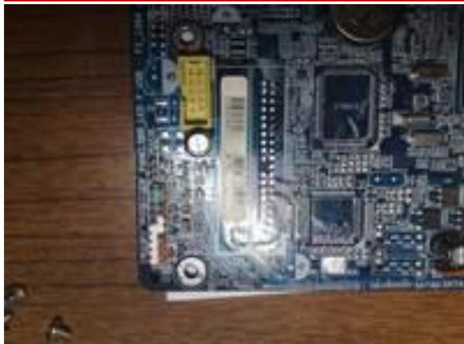
11. На материнской плате могут находиться разъёмы для подключения дополнительных USB – портов, которые могут например находиться на лицевой панели корпуса системного блока.
