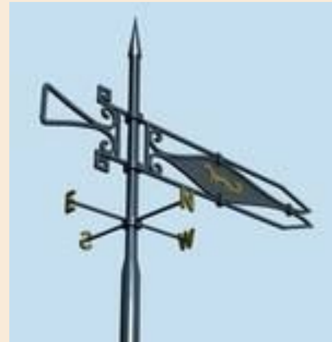
флюгер – прибор, определяющий направление и скорость ветра
