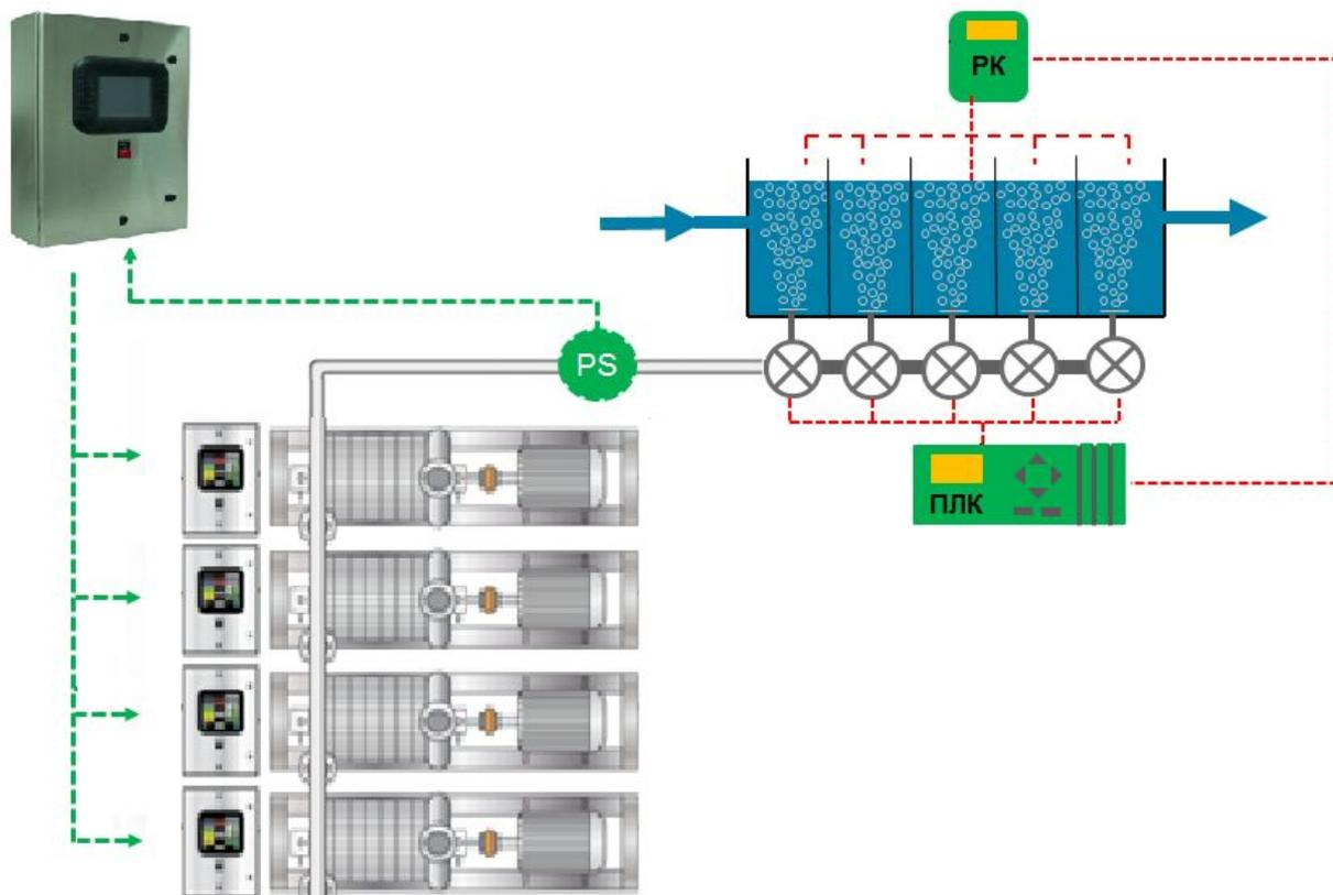
Управление воздушодувками происходит по давлению в сети, на участке от фланцев нагнетания воздушодувок до регулируемых задвижек на аэротенке.
