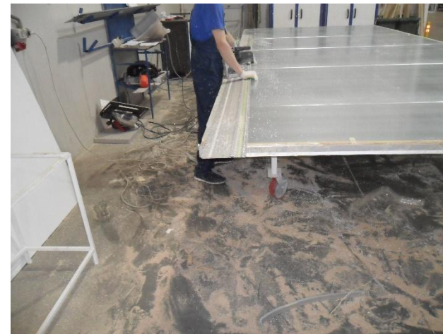
Торцовка сэндвич панели.
