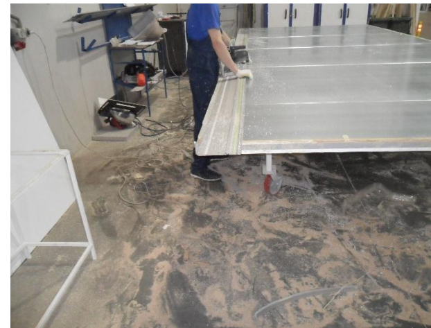
Торцовка сэндвич панели.
