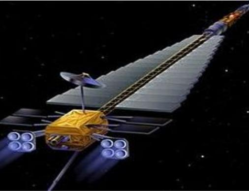
Ядерная электродвигательная установка — двигательная установка космического аппарата, включающая в себя комплекс бортовых систем: электрический ракетный двигатель, систему электропитания от ядерного реактора, систему хранения и подачи рабочего тела, систему автоматического управления. В отличие от ядерного ракетного двигателя, реактор ядерной электродвигательной установки вырабатывает тепловую энергию, которая преобразуется в электрическую и далее расходуется на работу двигателя.
