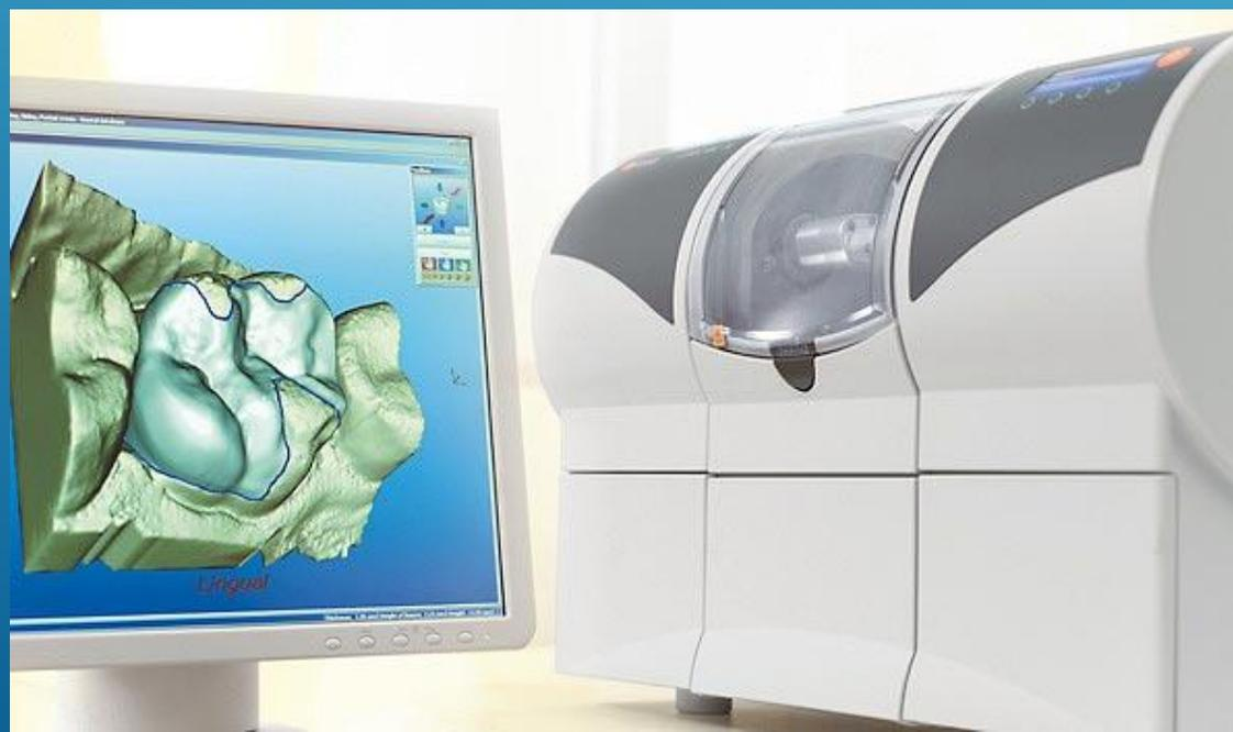
*Действительно, на фазе, названной «САД», производится сканирование элементов челюсти. После получения компьютерной 3D-модели, наступает фаза «САМ», которая предполагает создание протеза при помощи технологии Сат либо других технологий, таких как стереолитография и лазерное спекание.*
