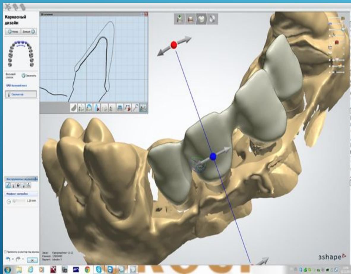
1. **Сам.** Программное обеспечение Cad преобразовывает виртуальную модель в определенный набор команд, которые передаются на производственный модуль Сам, где протез изготавливается путем вырезания из готового блока с использованием вращающихся алмазных или твердосплавных боров и дисков. Это, подход получил название «отнимающий метод».
