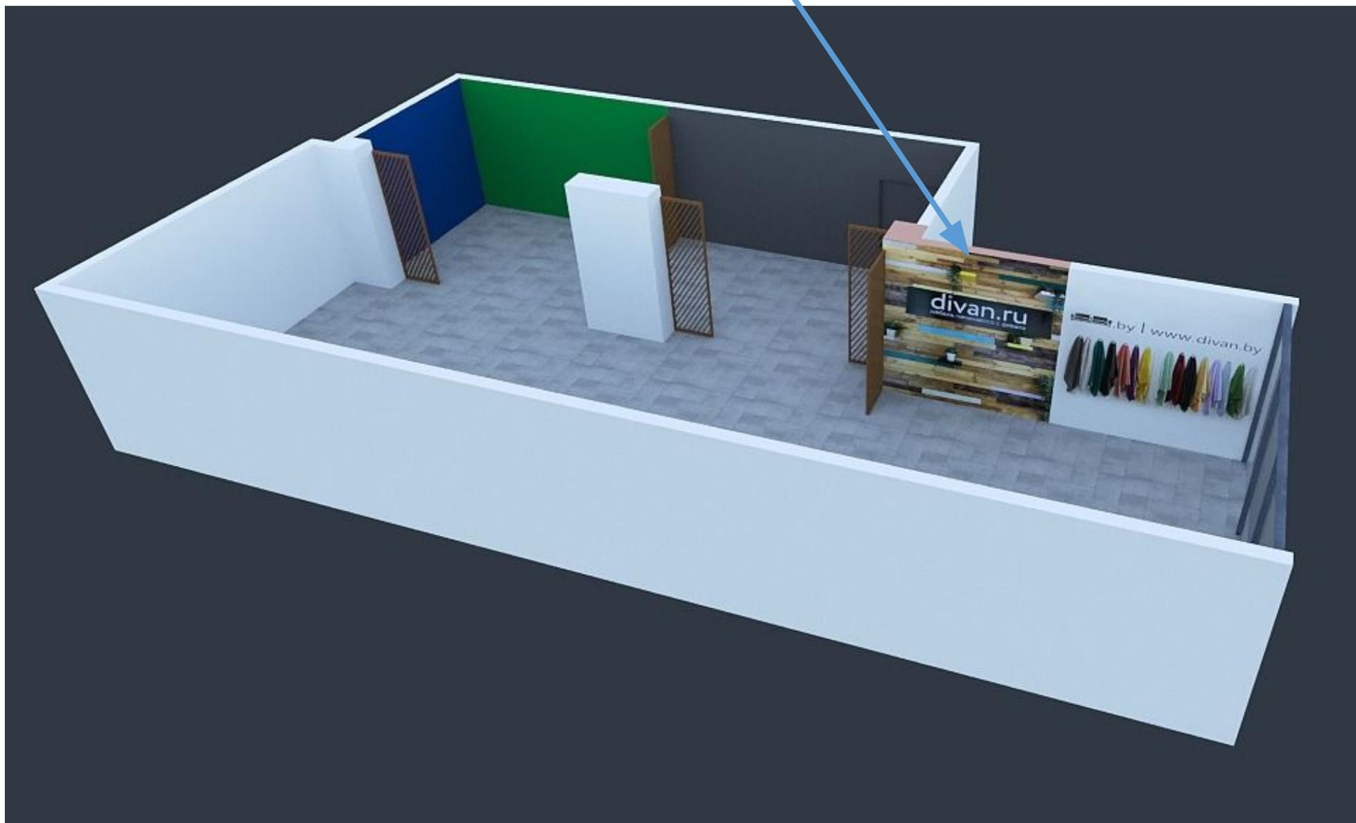
Для оформления зоны используются **не обработанные обрезные доски**, различной ширины **100мм., 150мм., 200 мм., 250 мм.** Толщина всех досок **20 или 25 мм.**
