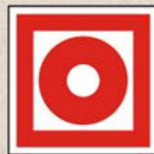
Кнопка пожарной автоматики
