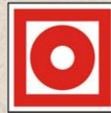
Кнопка пожарной автоматики
