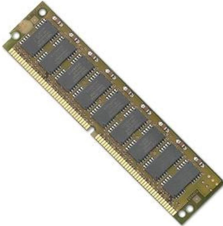
Модуль памяти с односторонним расположением выводов. Это небольшая плата с несколькими чипами памяти, которая устанавливается в соответствующий разъем на системной плате. Такая конструкция использовалась для устаревших типов памяти FRM и EDO.
