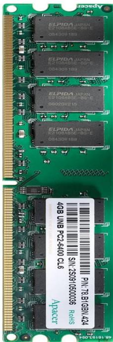
Эта память представляет собой дальнейшее *развитие технологии DDR*: в ней за счет усовершенствования внутренней архитектуры модуля достигается уже *четырёхкратное увеличение объема передаваемых данных за один такт в сравнении с SDRAM*. Модули памяти DDR2 широко используются в современных компьютерах и выпускаются в нескольких вариантах, различающихся тактовой частотой. Модули DDR2 могут иметь обозначения DDR2-400(PC2-3200), DDR2-533(PC2-4200), DDR2-677 (PC2-5300),
