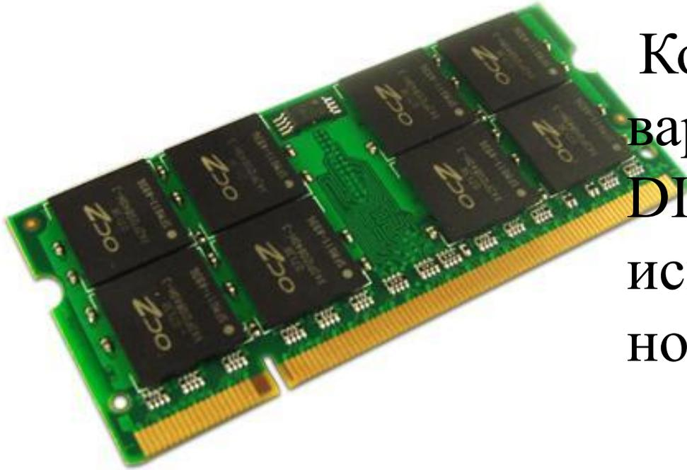
Компактный вариант модуля DIMM, который используется в ноутбуках.
