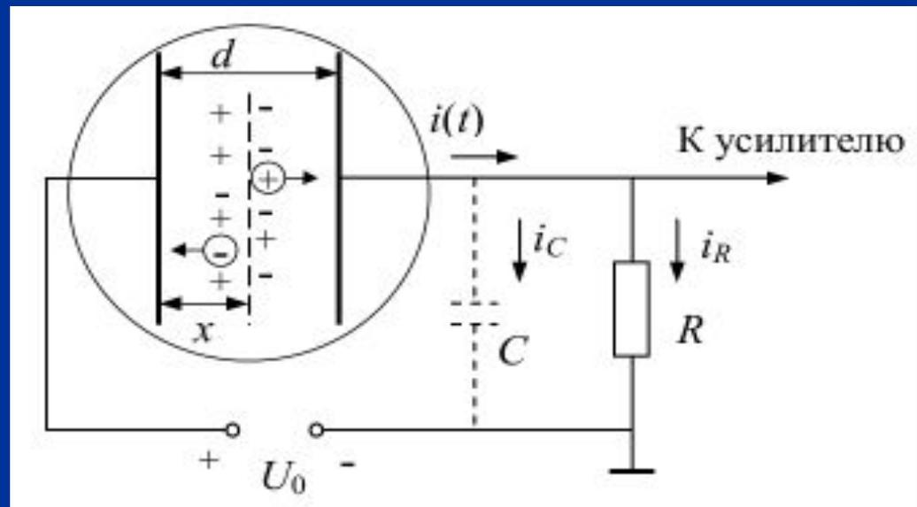
Пропорциональный счетчик- газовый детектор ионизирующего излучения, в основе принципа работы которого лежит процесс газового усиления в цилиндрическом электрическом поле
