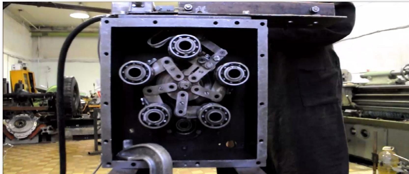
Рис.3 Кинематика генератора механических колебаний
