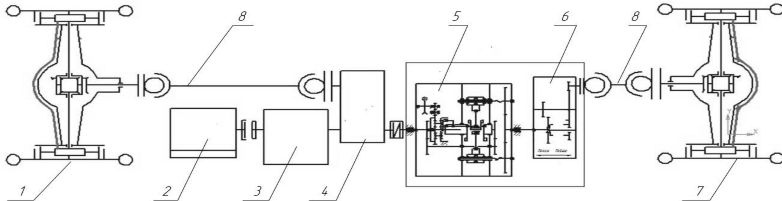
Рис. 5. Кинематическая схема работающего испытательного образца' коробка передач. 1 - передняя ось, 2 - двигатель внутреннего сгорания, 3 - стандартная коробка передач, 4 – стандартная раздаточная коробка, 5 – прототип механической бесступенчатый коробка передач, 6 – раздаточная коробка заднего моста, 7 – задний мост, 8 – карданный привод.
