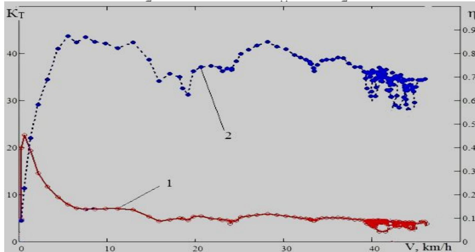
Рис. 17. Экспериментальные значения коэффициента преобразования крутящего момента  $K_T$  и КПД  $\eta$  механической бесступенчатой трансмиссии в зависимости от скорости автомобиля  $V$ , 1 -  $K_T$ ; 2 -  $\eta$
