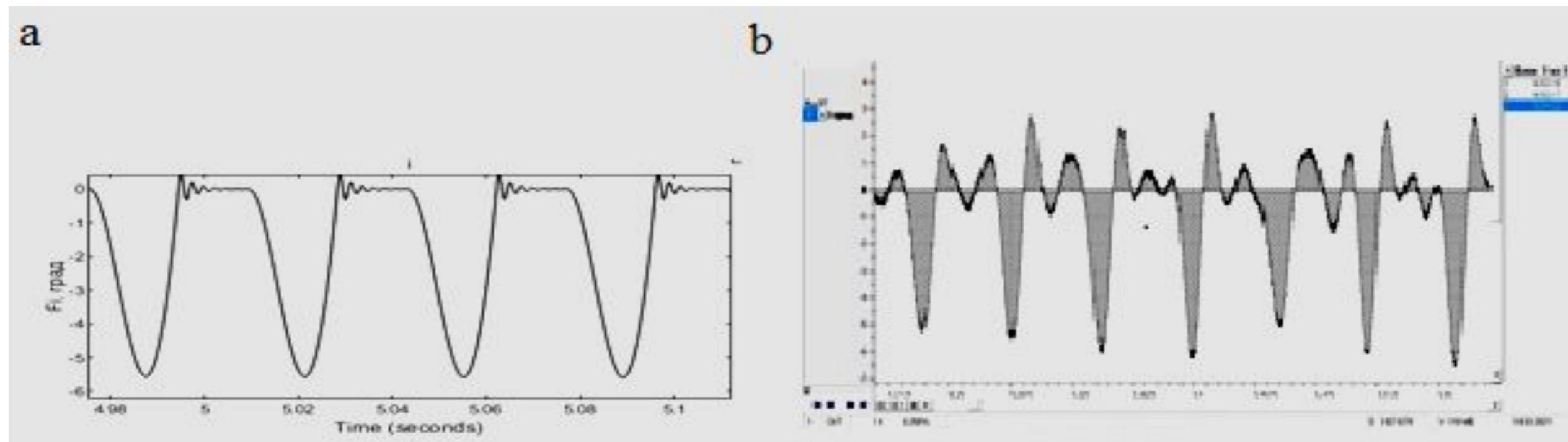
Рис. 16.(а) Результаты расчета углов закрутки торсионного вала на 5-6 секундах процесса ускорения; (б) результаты экспериментов (фрагмент осциллограмма).
