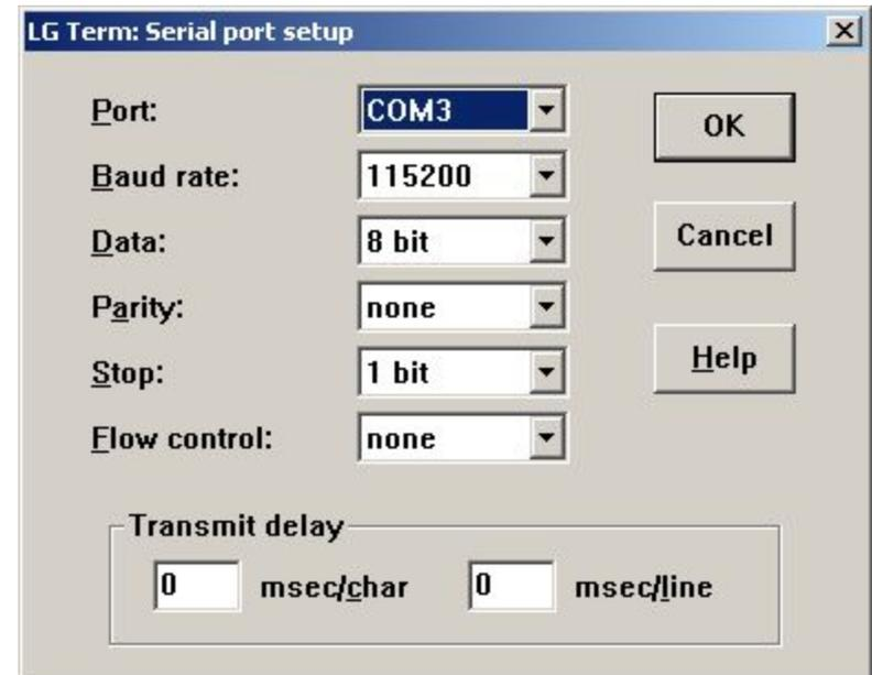
Подключите TV или к serial port на компьютере или к FTDI джигу
