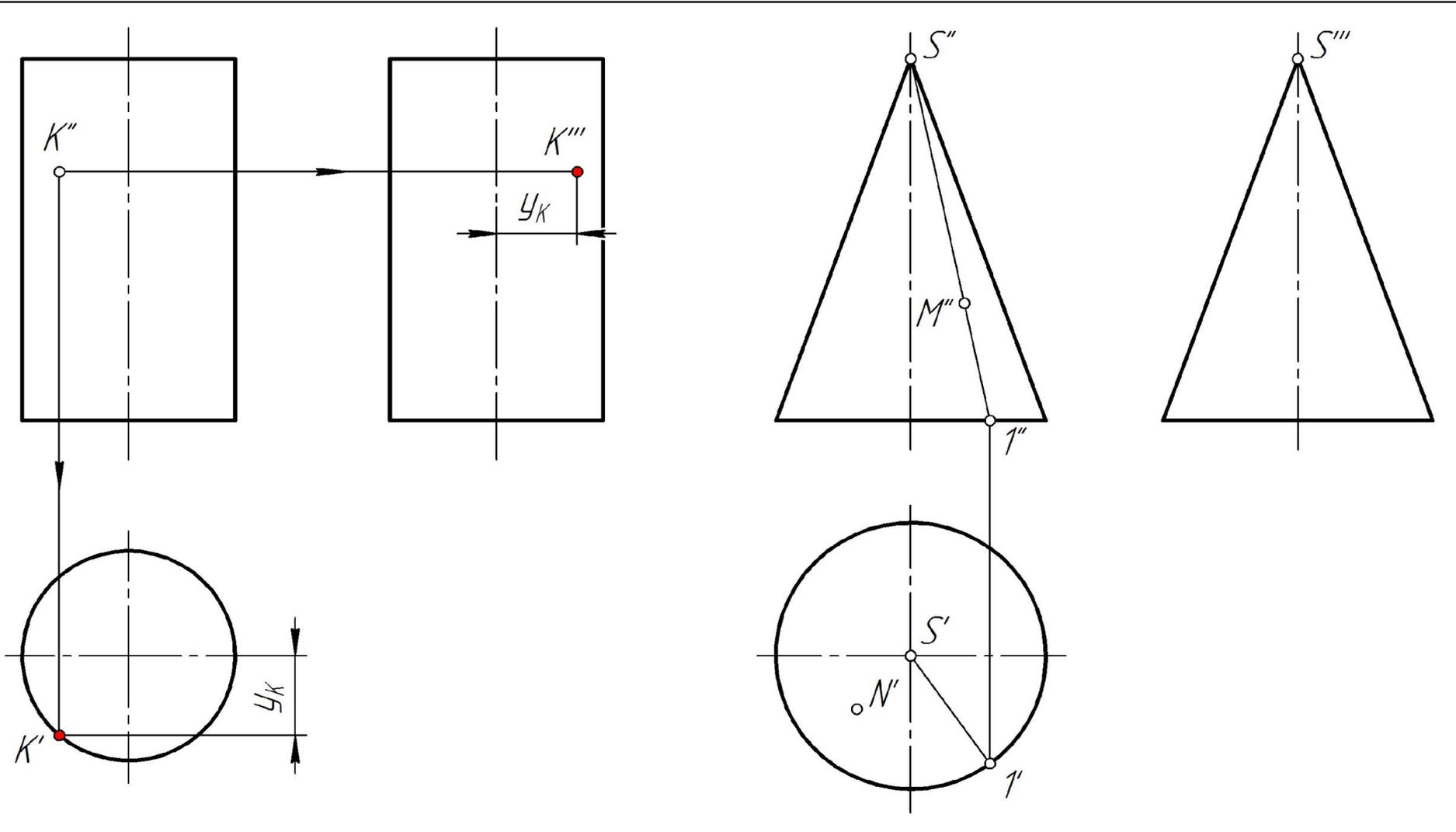
Задача. Построить проекции точек, принадлежащих поверхностям (рис. 34).
