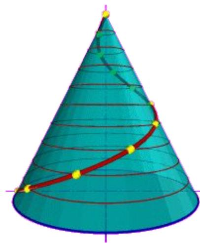
Винтовая линия образуется при винтовом движении точки, т.е. при повороте точки вокруг неподвижной оси и одновременном перемещении точки вдоль оси.
