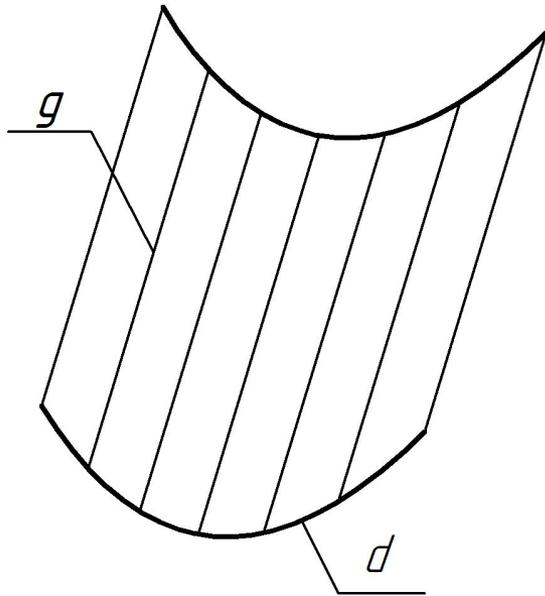
Задание поверхности с помощью каркаса
