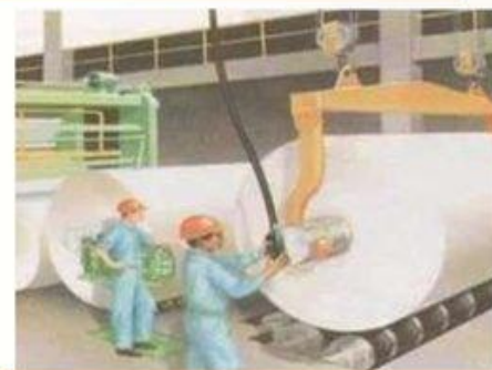
Тяжёлые валы прессуют древесную массу в тонкий лист. Горячие валы высушивают её.
