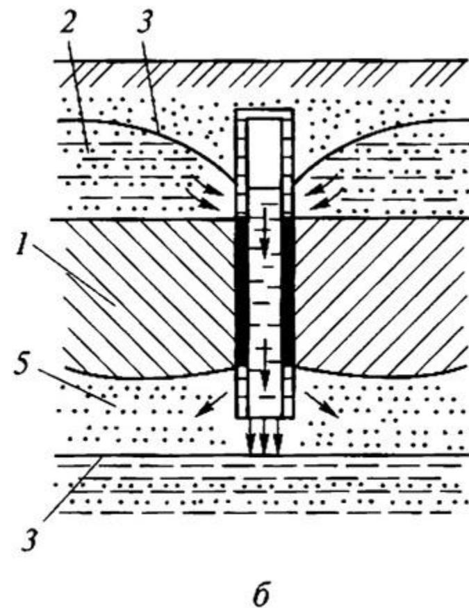
Схема работы дренажных колодцев вертикального дренажа: а — с откачкой воды; б — с поглощением воды в грунт; 1 — водонепроницаемый слой; 2 — осушаемый водопроницаемый слой; 3 — уровень грунтовых вод; 4 — насос; 5 — поглощающий водоносный слой
