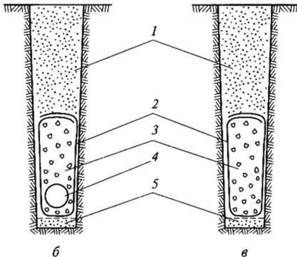
. Узкотраншейные системы дренажа (размеры указаны в м): а — с дренажным матом «Енкадрайн» (рекомендации фирмы): 1 — ловчая дрена; 2 — енкадрайн; 3 — материнский грунт; 4 — обратная засыпка местным грунтом; 5 — геодрен; 6 — фильтр из геотекстиля; б — с материальной дрена и щебневым фильтром; в — щебневой дренаж: 1 — обратная засыпка песком; 2 — геоткань; 3 — щебневой фильтр; 4 — дрена с префильтром; 5 — донный
