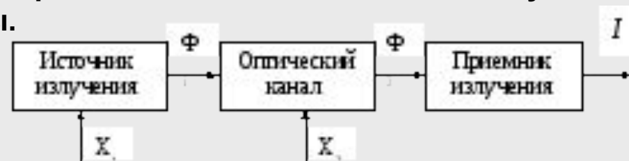
Рис. 1 – обобщенная структурная схема оптоэлектрического преобразователя семейства характеристик МРП.
