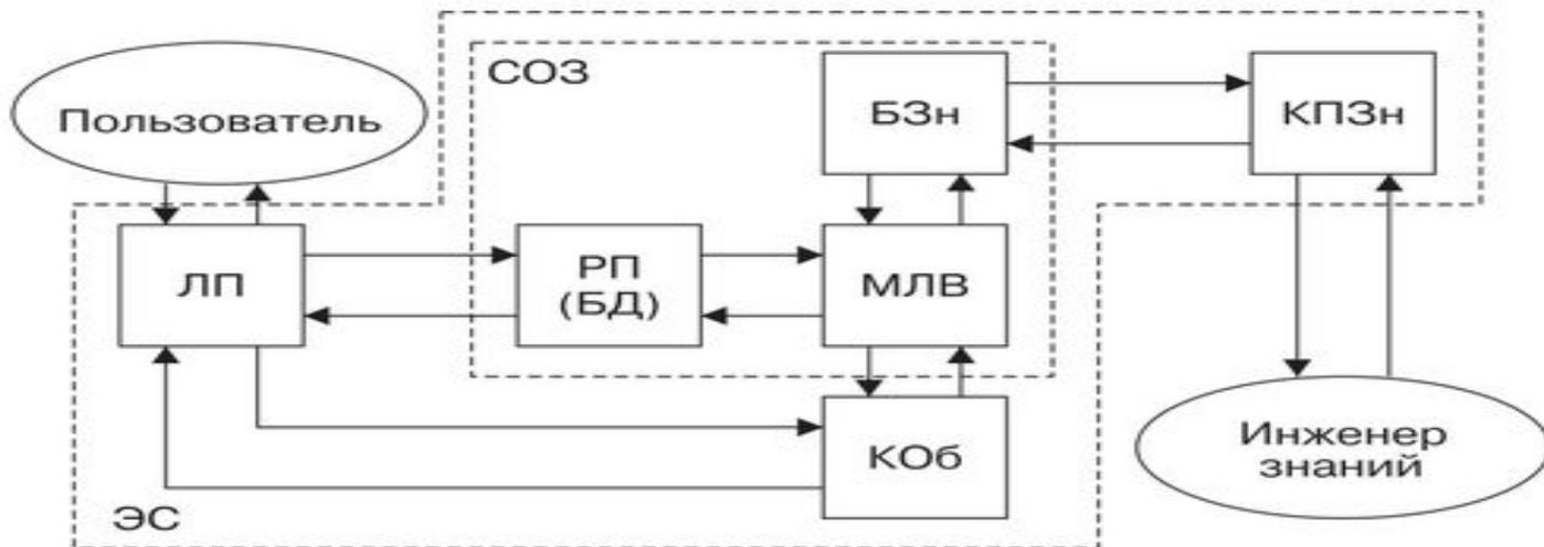
**Рис. 3.15.** Структура экспертной системы:
