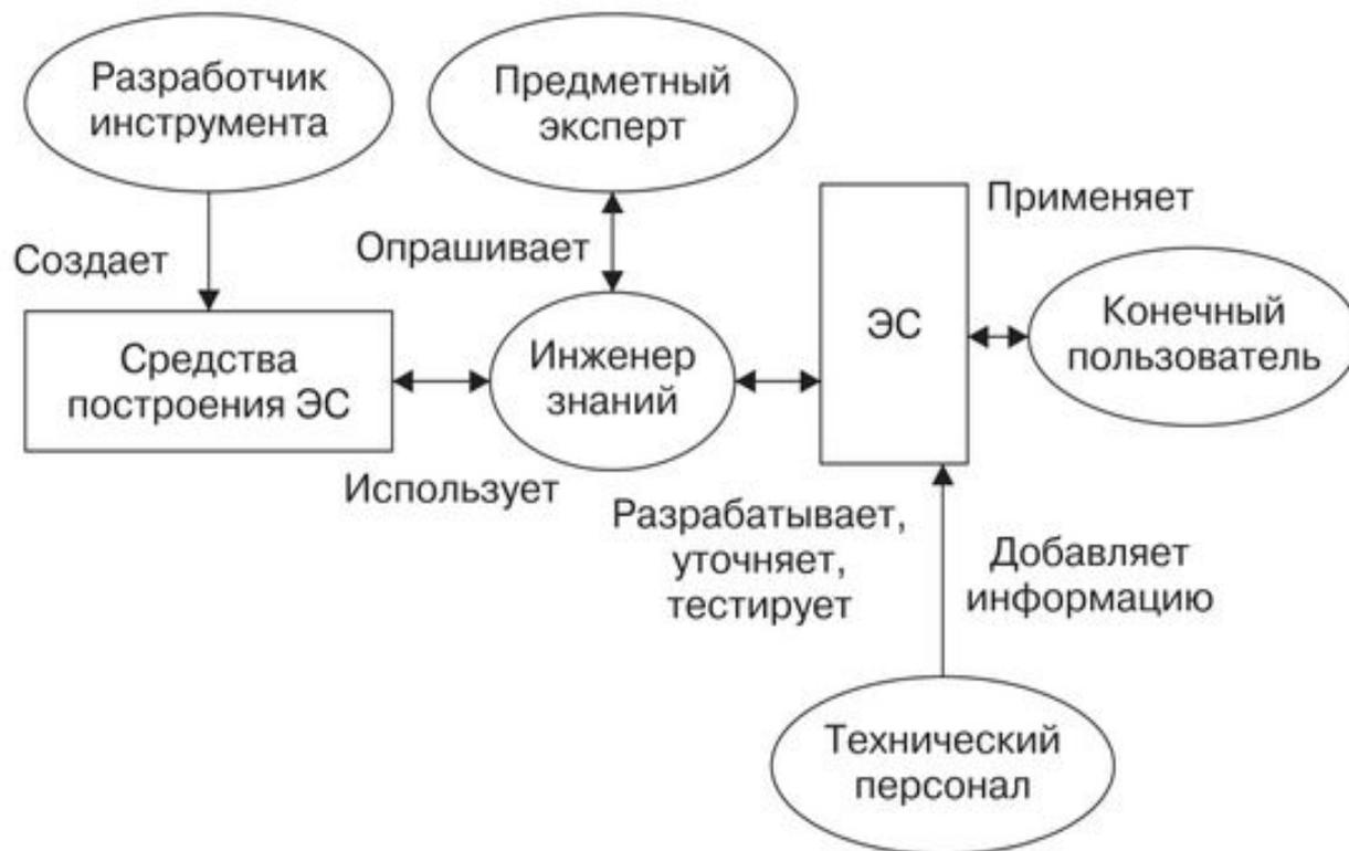
**Рис. 3.21.** Схема взаимодействия создателей экспертной системы
