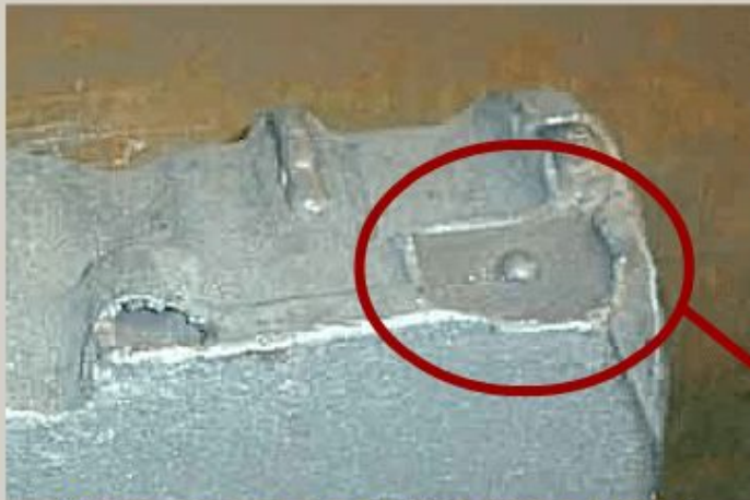
Отливка с рассматриваемым дефектом
