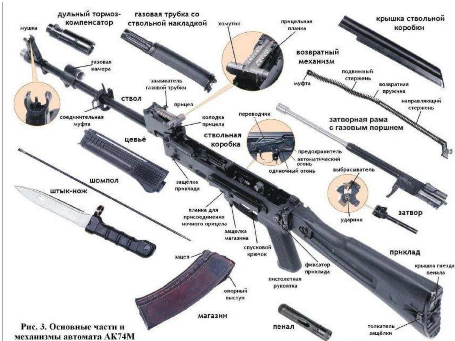
Рис. 3. Основные части и механизмы автомата АК74М
