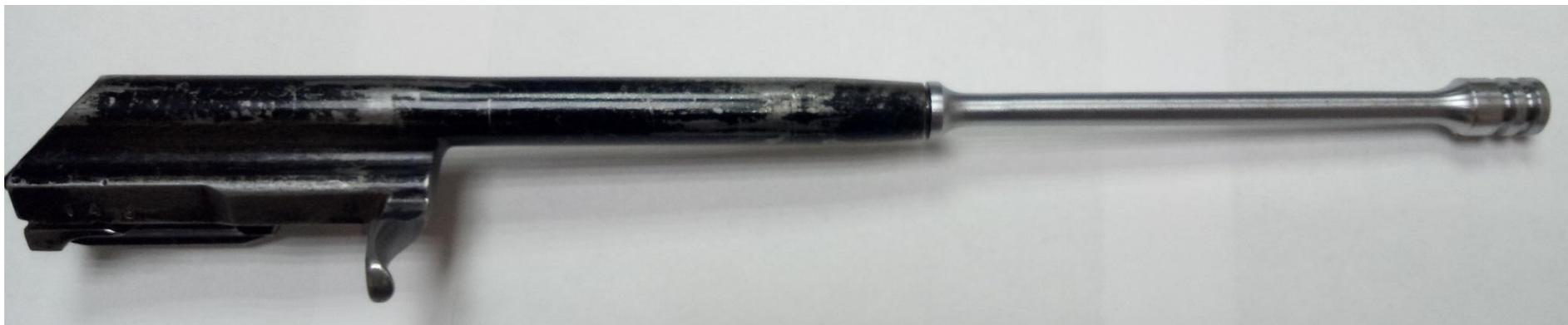
**5. Затвор служит** - для досылания патрона в патронник, закрывания канала ствола, разбивания капсюля и извлечения из патронника гильзы (патрона). Он состоит из остова, ударника, выбрасывателя с пружиной и осью, шпильки.
