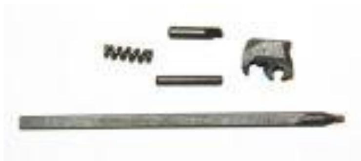
**6. Возвратный механизм** - служит для возвращения затворной рамы с затвором в переднее положение. Он состоит из возвратной пружины, направляющего стержня, подвижного стержня и муфты.
