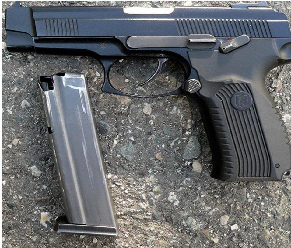
**Пистолет Ярыгина** - является личным оружием нападения и защиты, предназначенным для поражения целей, с использованием 9 мм пистолетных патронов с пулей повышенной пробиваемости (индекс 7Н21), на дистанции до 50 м пробивает бронежилеты 1,2,3 класса.
