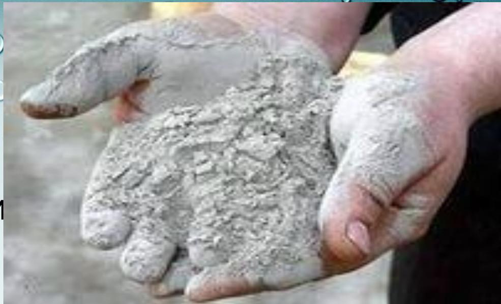
Вяжущими элементами называются одно или многокомпонентные порошкообразные минеральные вещества, образующие при смешивании с водой пластичную формируемую массу, затвердевающую при выдержке в прочное камневидное тело.
