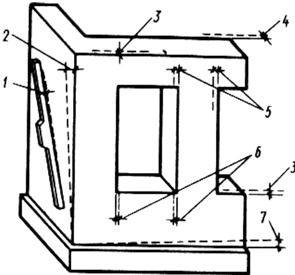
Допускаемые отклонения при возведении стены из керамического камня, мм: 1 - вертикальной поверхности - 10 мм; 2 - поверхностей углов по вертикали: на этаж - 15 мм, на всю высоту стены - 30 мм; 3 - отметки обреза - 10 мм; 4 - толщины кладки  $\pm 15$  мм; 5 - ширины простенков - 15 мм; 6 - ширины проемов  $\pm 15$  мм; 7 - рядов кладки от горизонтали на 10 м длины - 15 мм
