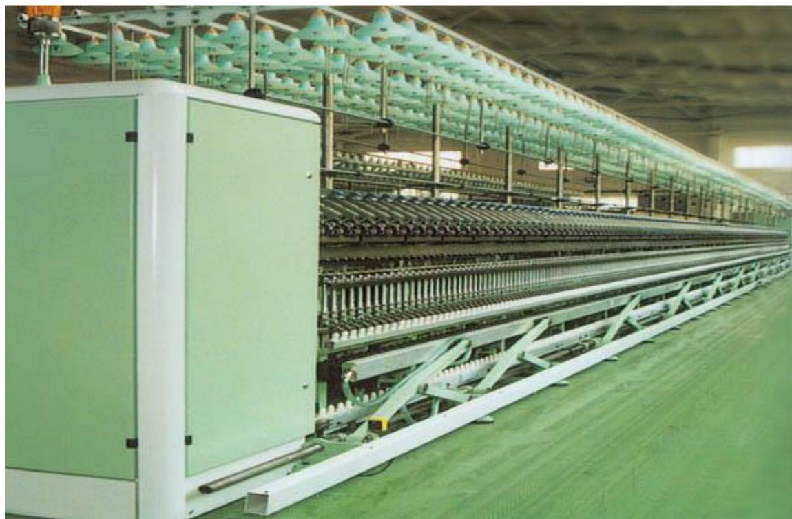
**Новая конструкция вязальной машины.** Машина снижает обрывность нити в 8-10 раз и экономит (в 3-4 раза) занимаемые производством площади. Лицензия на промышленное производство прядильной машины уже передана КНР.
