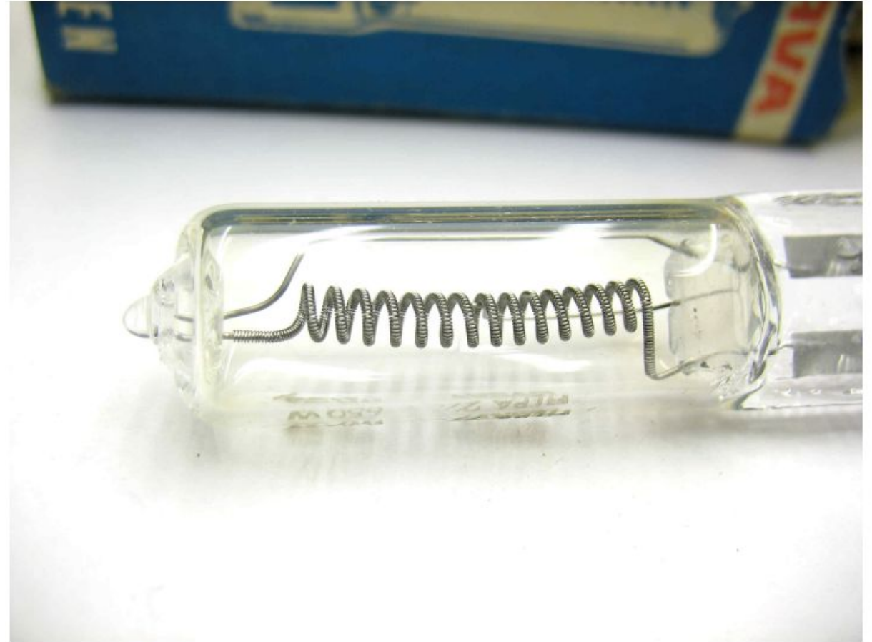
Рисунок 2.17 Нить накаливания этой галогеновой лампы изготовлена из вольфрама. Галоген, обычно пары иода, химически связывает испаряющийся с нити вольфрам и возвращает его на нить, что позволяет повысить температуру накала спирали и уменьшить габарит лампы без страха, что вольфрам постепенно оседет на стенках колбы.
