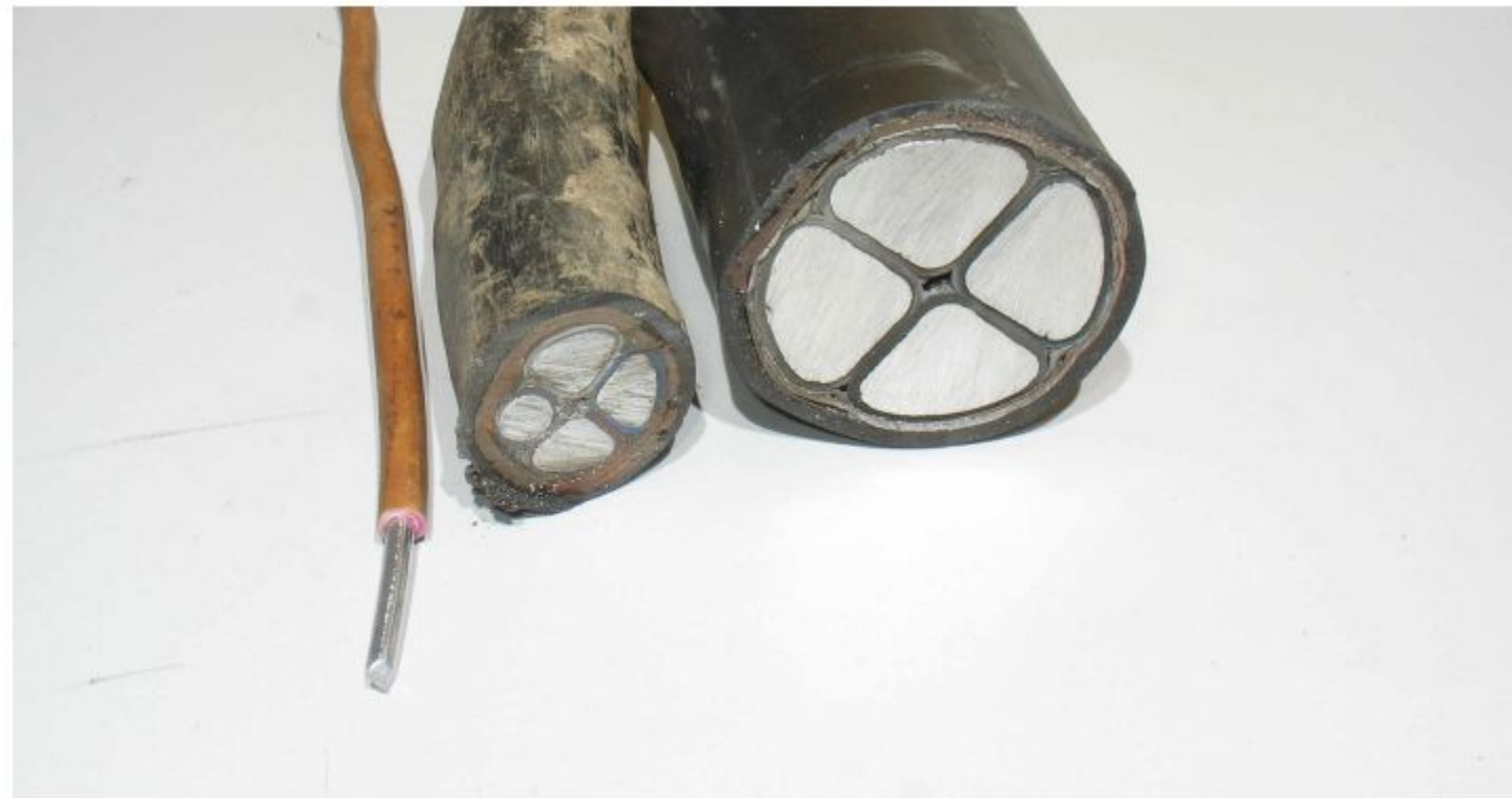
Рисунок 2.7 Слева старый алюминиевый провод. Справа алюминиевые кабели различного сечения, пригодные для укладки в грунт. В частности, кабелем справа был подключен к электроэнергии целый этаж здания. Кабель помимо наружной резиновой оболочки имеет бронирующую стальную ленту для защиты нижележащей изоляции от повреждений, к примеру, лопатой при раскопке.
