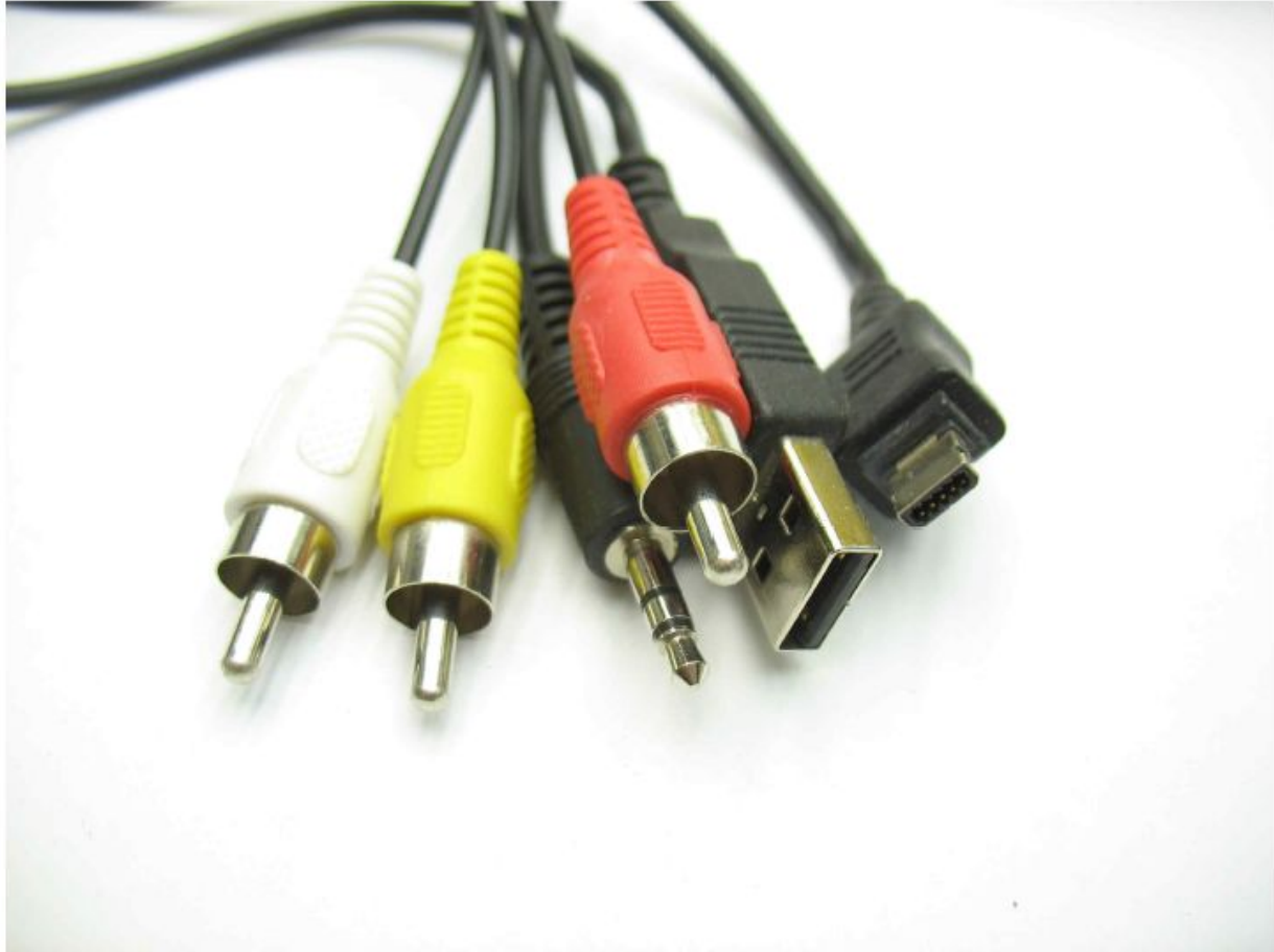
Рисунок 2.15 Различные разъемы, покрытые никелем для надежного контакта.
