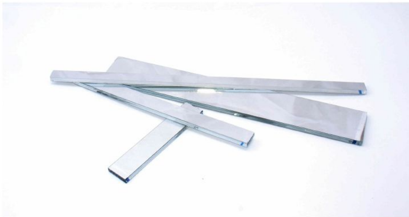
Рисунок 2.9 Зеркала от оптической системы планшетного сканера. Обратите внимание, оптические зеркала имеют металлизацию стекла снаружи, в отличие от привычных бытовых зеркал, где отражающее покрытие для защиты за стеклом. Бытовые зеркала дают двойное отражение — от поверхности стекла и от отражающего покрытия, что не так критично в быту, как защищенность отражающего покрытия.
