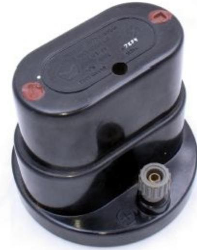
Рисунок 2.20 Элемент нормальный насыщенный, НЭ-65, класс точности 0,005. Внешний вид корпуса нормальных элементов может различаться. Ниже - содержимое корпуса, видна ртуть в нижней части колб. Такие элементы должны утилизироваться специализированной организацией.
