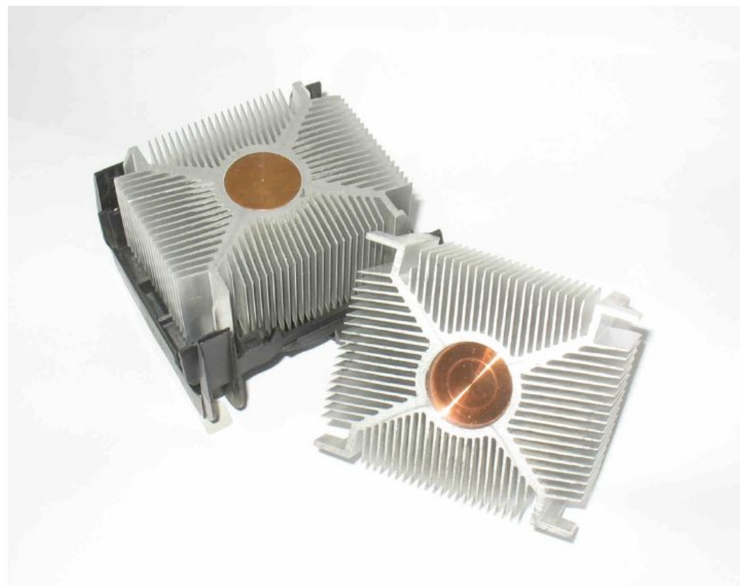
Рисунок 2.5 Радиаторы охлаждения процессора. Центральный стержень изготовлен из меди, он хорошо отводит тепло от кристалла процессора, а алюминиевый радиатор с развитым оребрением уже охлаждает сам стержень.
