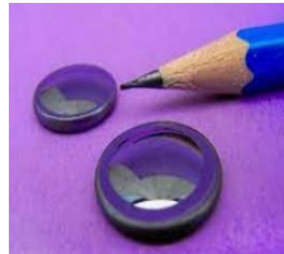
Сегодня линзы в тепловизорах делаются из кристаллического германия, селенида цинка или сульфида цинка. Эти материалы не только дороги, они ещё и обрабатываются лишь механически (включая перемалывание, полировку, алмазное точение и иные этапы). Оттого тепловизоры не по карману большинству потребителей. Зачем они им (нам)?
