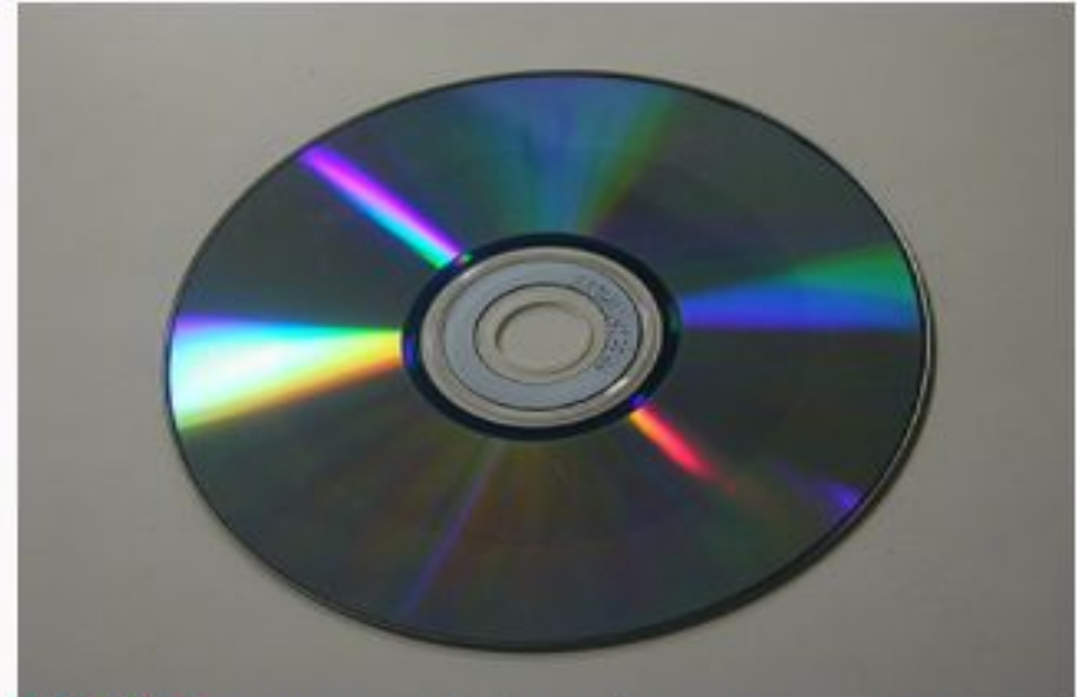
CD-RW (компакт - диск). Аморфные халькогениды составляют основу технологии твердотельной памяти перезаписываемых CD и DVD. [2]
