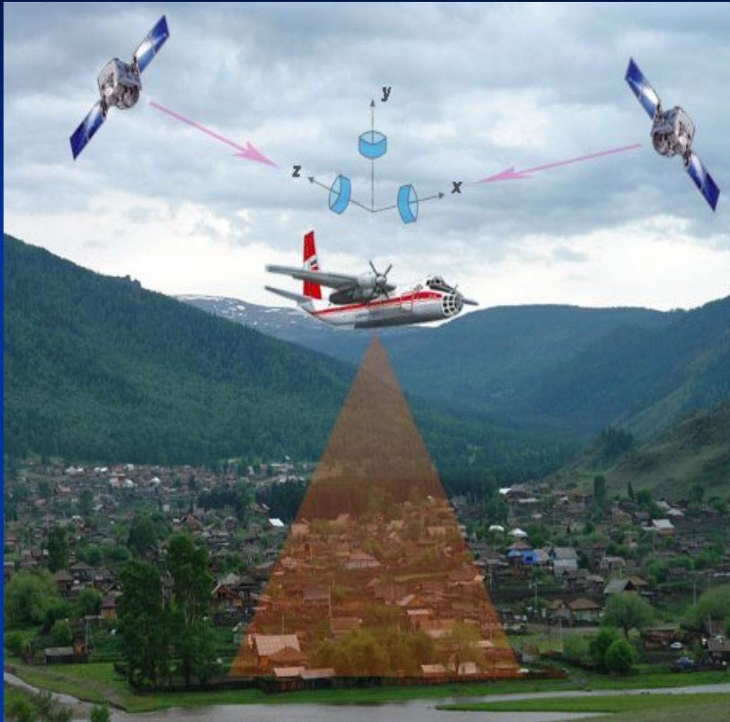
В процессе лазерного сканирования полосы местности, лидар излучает лазерные импульсы в плоскости, перпендикулярной направлению полёта. Часть энергии излучённых лазерных импульсов отражается от земли, растительности и объектов, и регистрируется приемной системой лидара.
