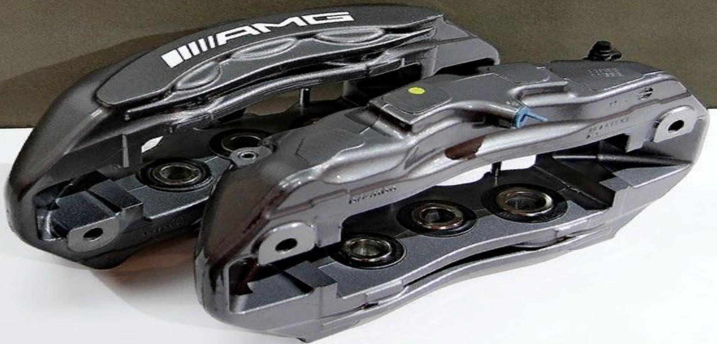
Чем больше поршней (4, 6, 8) в суппорте, тем равномернее распределяется на диске давление во время торможения, тем самым нагрузка на диск и колодки сокращается, а также уменьшается вибрация. Такие суппорты однозначно повышают эффективность тормозной системы
