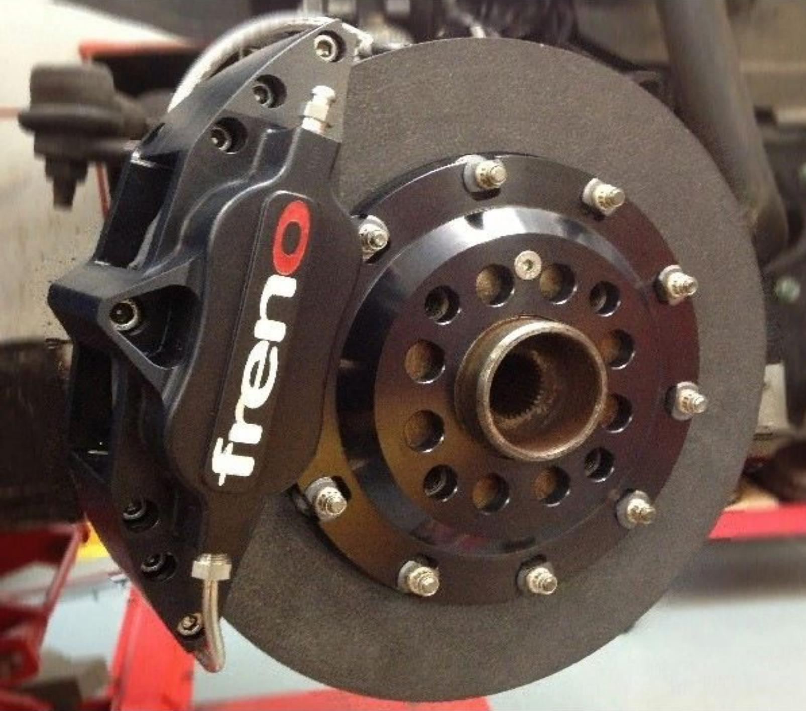
Обеспечивают хорошее трение, менее склонны к генерации тепла. Карбоновые диски предназначены для спортивных автомобилей, поэтому для обычных машин не совсем подходят, так как им необходимо хорошо прогреться для корректной работы
