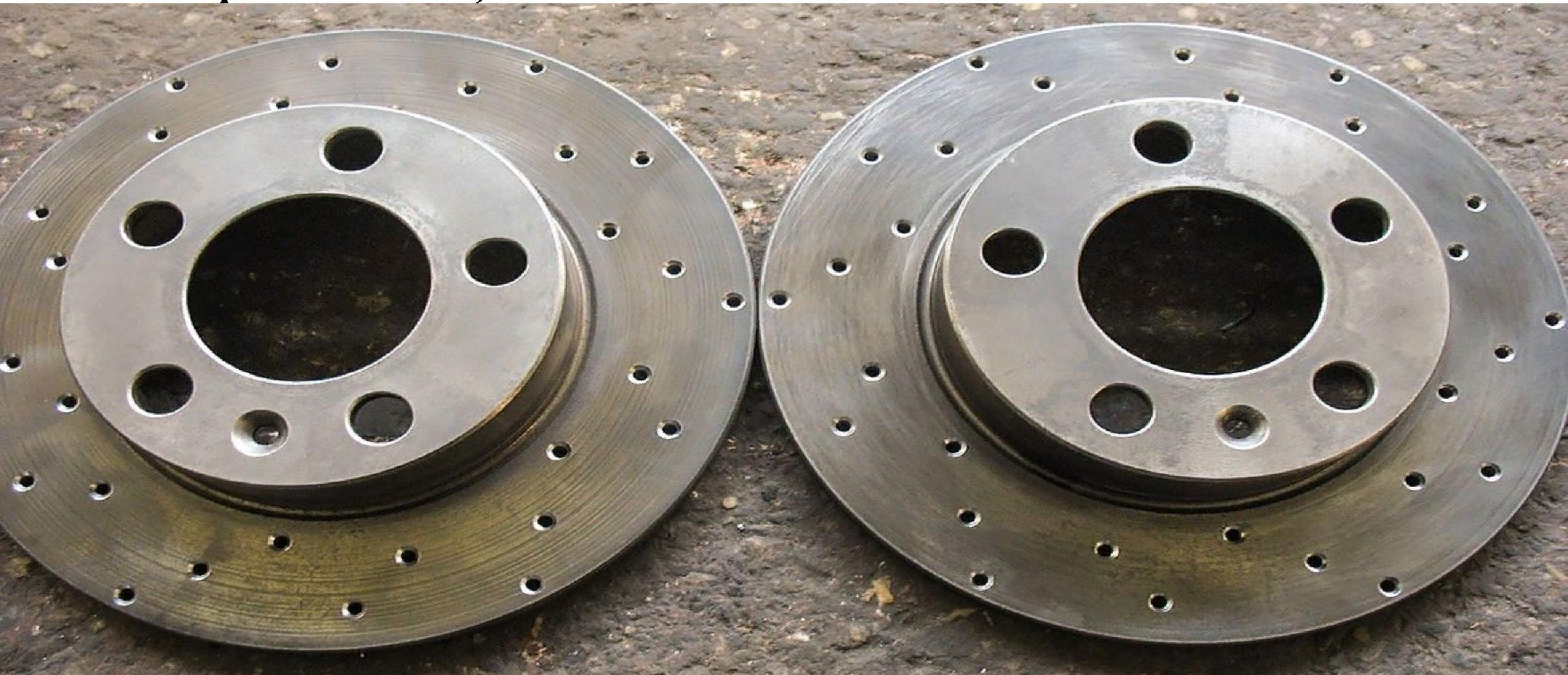
Отталкивают воду, газ, охлаждаются и способствуют удалению частиц грязи и нагара. Диски с поперечным сверлением имеют один недостаток — со временем вокруг просверленных отверстий появляются трещины и надломы
