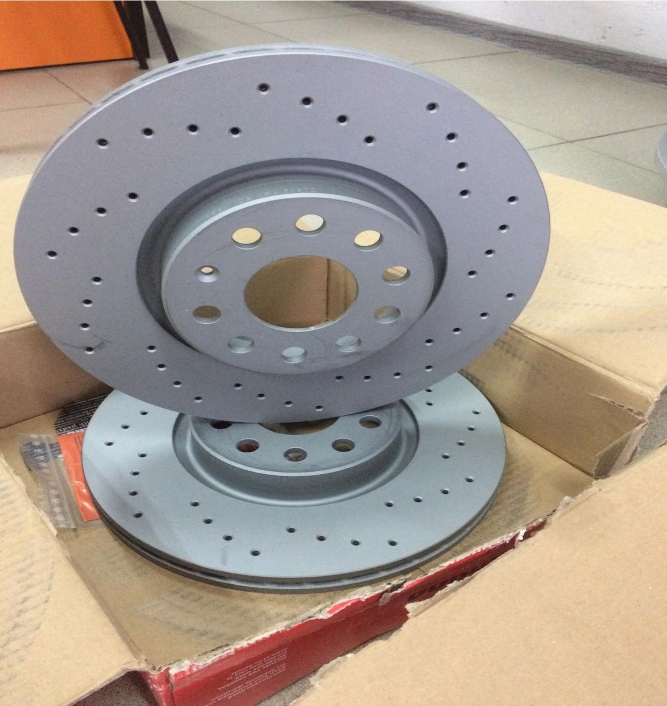
Внешне такой диск напоминает два склеенных между собой отдельных диска, разделенных лопатками воздухоотводов. Пустое пространство способствует вентиляции, позволяя воздуху проходить сквозь диск во время вращения, охлаждая его
