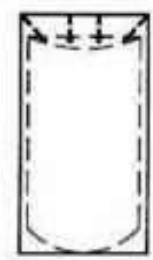
Труба, подвешенная в старой силосной башне
