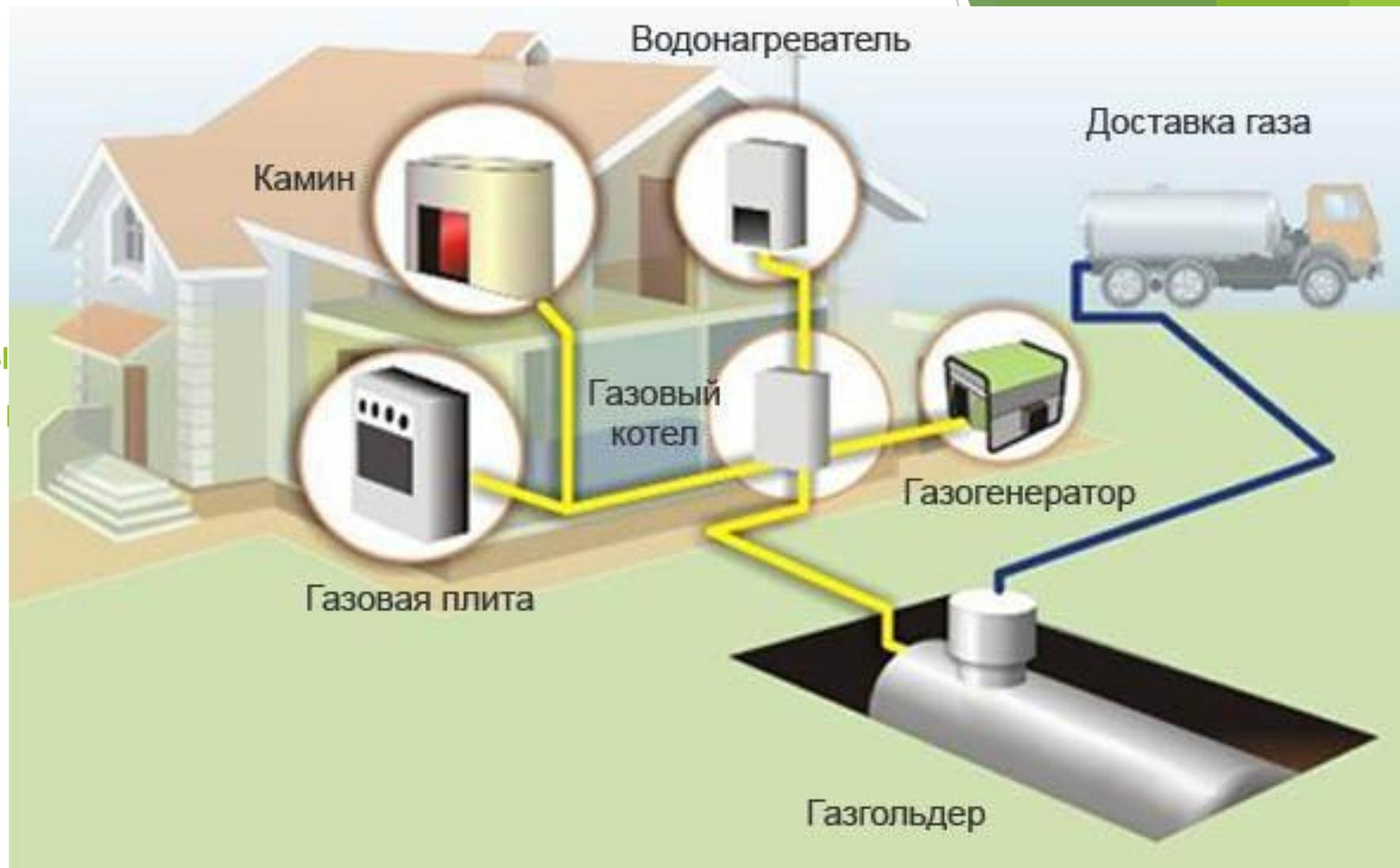
Для компенсации суточной неравномерности газопотребления используют также газгольдеры высокого и низкого давления - сосуды специальной конструкции.
