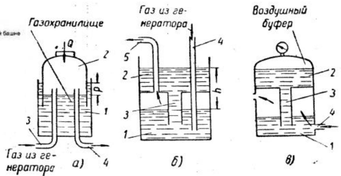
Фиг. 330. Схемы действия газгольдеров:
