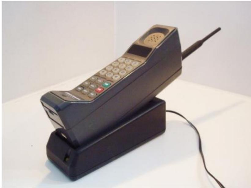
Массовое производство и коммерческие продажи DynaTAC 8000X начались спустя 10 лет после совершения первого звонка. Аппарат весил 800 г, работал на одном заряде аккумулятора примерно 1 час, имел одну мелодию, мог хранить до 30 телефонных номеров. Его стоимость составляла 4000 долларов.
