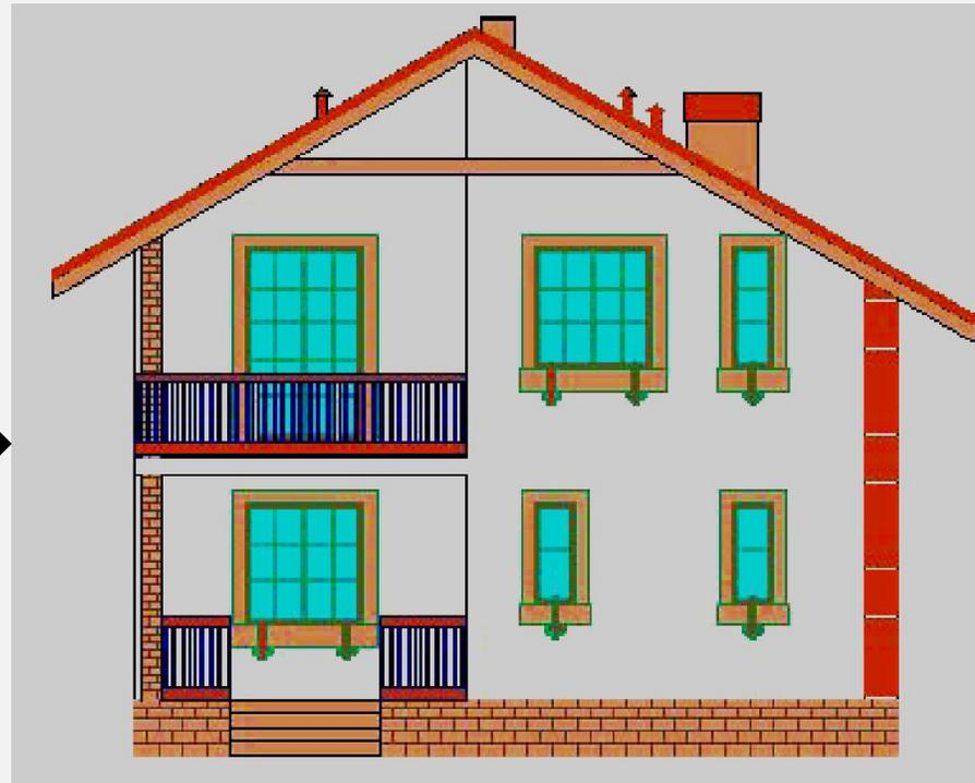
**ТЕХНОЛОГИЯ ВЫПОЛНЕНИЯ ФАСАДА ОТ РАЗРЕЗА ОТЛИЧАЕТСЯ НЕ СИЛЬНО. ФАСАД ВЫПОЛНЯЕТСЯ НА ОСНОВЕ КОНТУРА РАЗРЕЗА, ЛИШЬ ДОБАВЛЯЯ ВНЕШНИЕ АРХИТЕКТУРНЫЕ ЭЛЕМЕНТЫ.**
