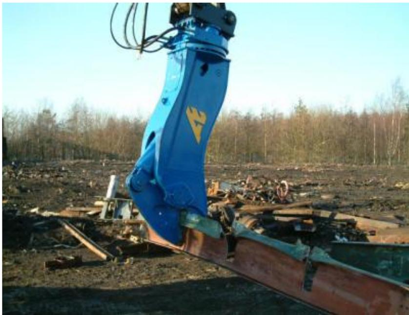
Функция гидравлических ножниц основана на сжатии объекта. Чем шире раскрытие ножниц, тем больший кусок они могут захватить. Сдавливающая сила должна распределяться равномерно и с достаточным усилием для разрезания захваченного куска. А чем короче процесс сжатия-раскрытия ножниц, тем быстрее будет процесс.
