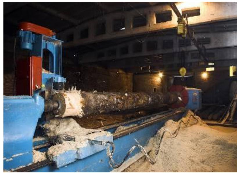
До ворот цеха плывут брёвна по реке или их везут в специальных вагонах. А здесь за дело берутся другие машины: многопильный станок распиливает брёвна на чурбаки, а машина-корообдирка сдирает с них кору.
