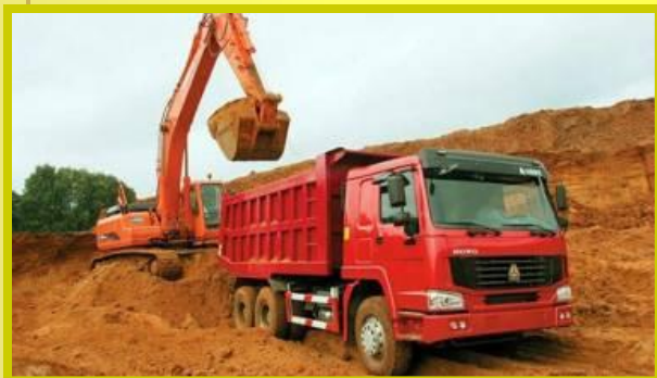
Глина добывается экскаваторами...
