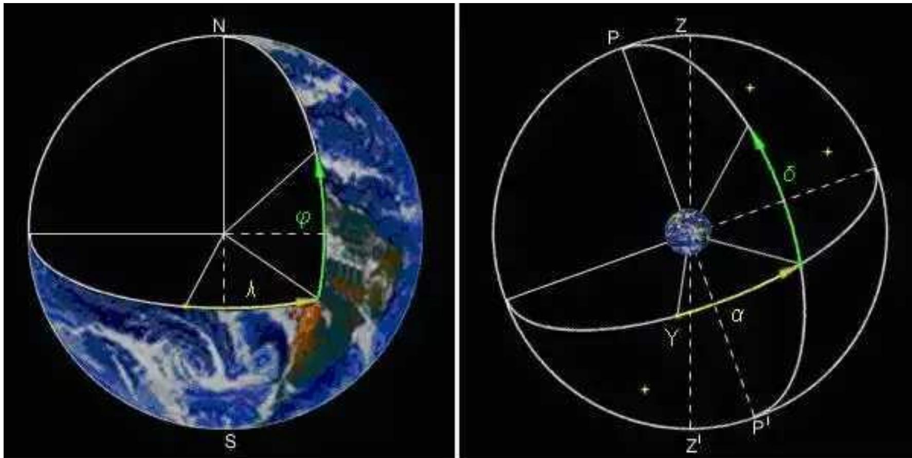
В **экваториальной системе координат** положение звезды связано с небесным экватором (пересечение плоскости земного экватора с небесной сферой),
