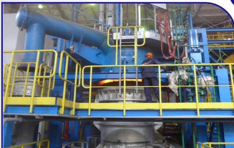
Вакуумирование (снижение содержания растворенных в стали газов: кислорода, азота и водорода)
