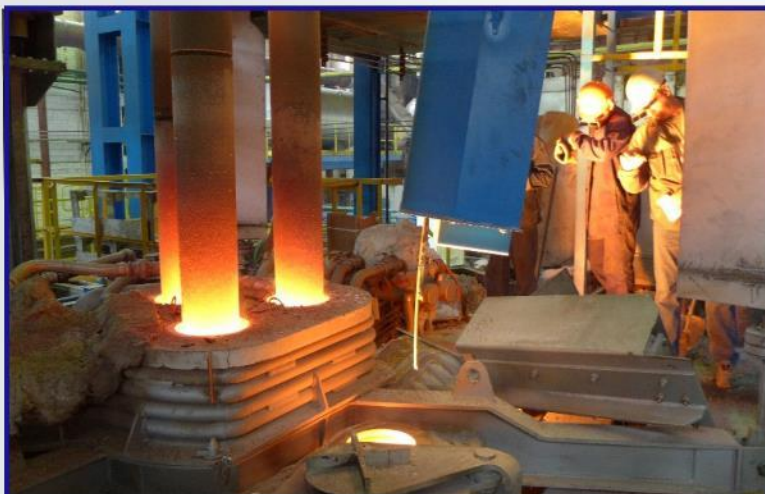
Получение жидкого полупродукта в дуговой печи
