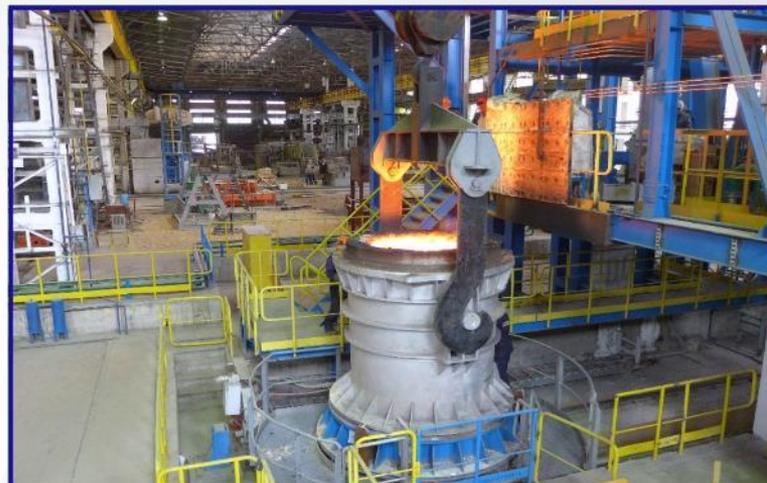
Печь-ковш - окончательная доводка стали по химическому составу
