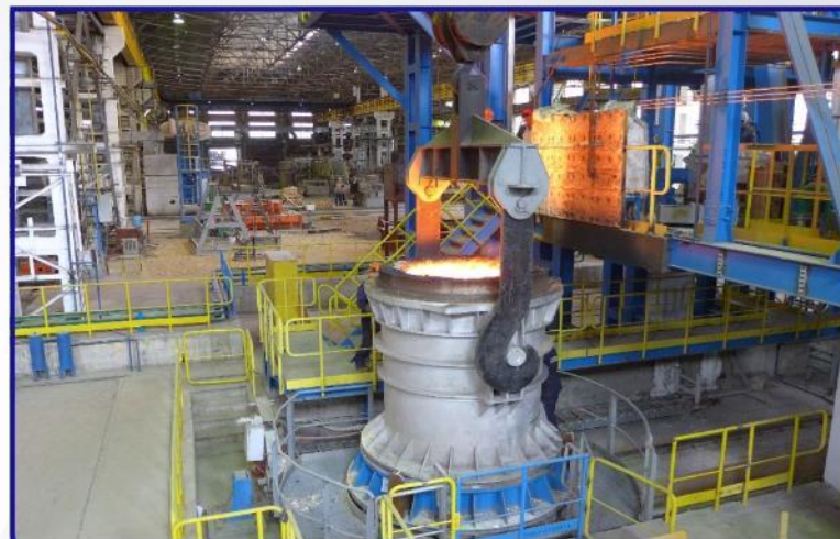
Печь-ковш - окончательная доводка стали по химическому составу
