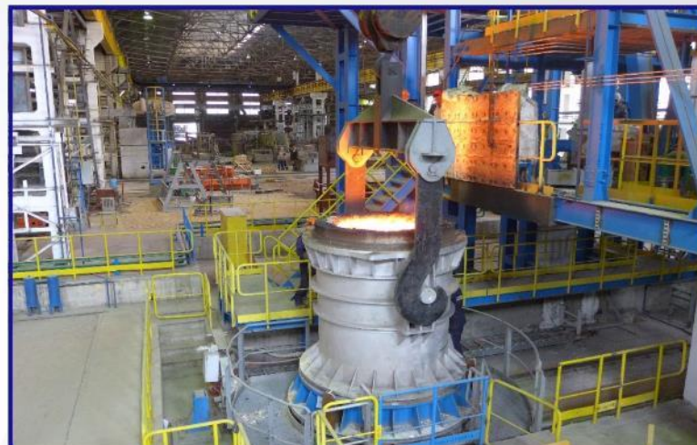
Печь-ковш - окончательная доводка стали по химическому составу
