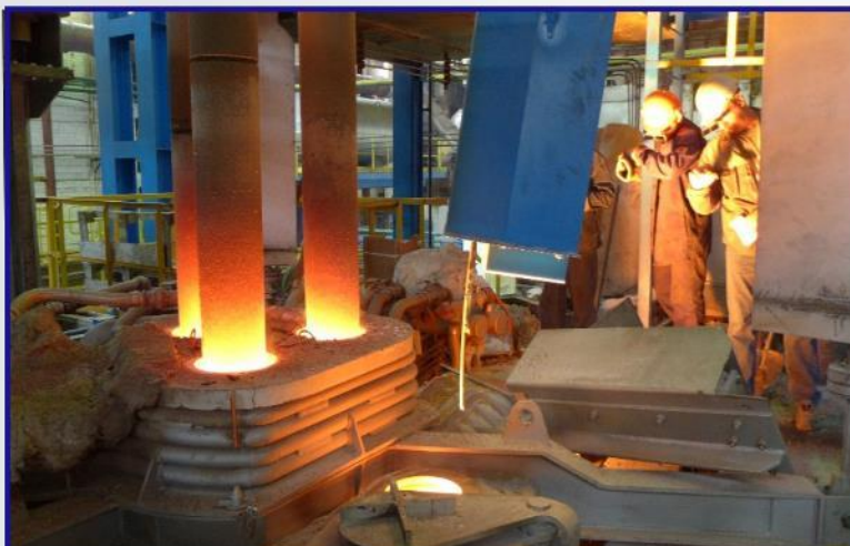
Получение жидкого полупродукта в дуговой печи
