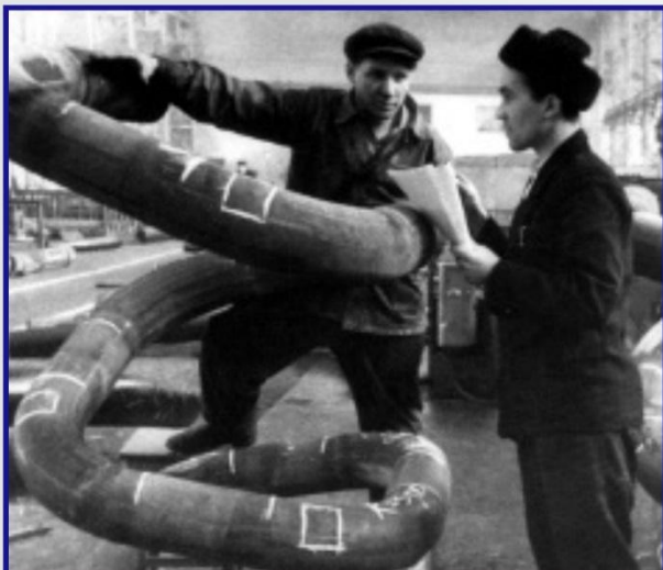
На заводе, впервые в стране, был изготовлен станок гибки труб с нагревами токами высокой частоты, 1956г.
