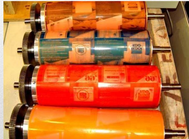
При **высокой печати** краска наносится на поверхность выступающих печатных элементов. Соприкасаясь под давлением с бумагой, краска с выступающих печатных элементов переходит на бумагу, Технология данного печатного процесса очень проста, печатные формы изготавливаются достаточно легко. Благодаря этим достоинствам, способ высокой печати долгое время пользовался заслуженной популярностью.
