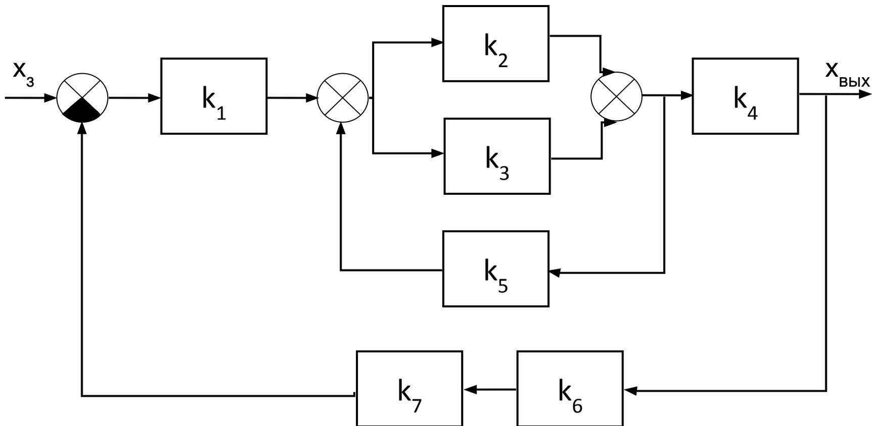
Правила преобразования в САУ. Результирующий коэффициент передачи (статика)
