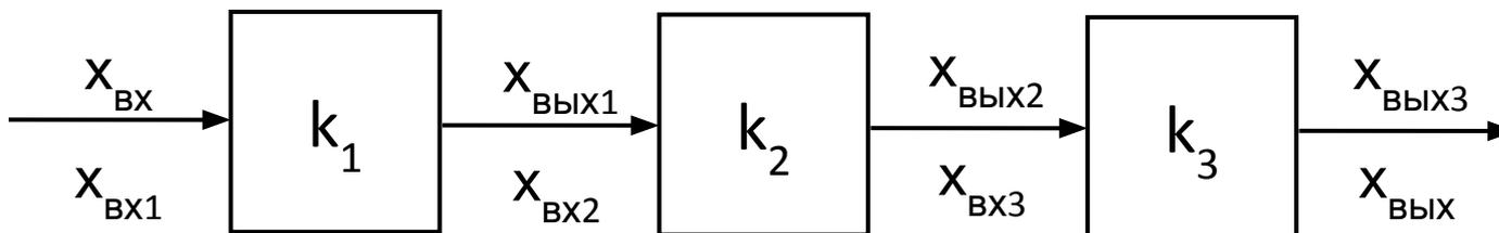
При  $n$  последовательно соединенных звеньях:
