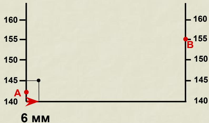
Следующая точка линии профиля имеет высоту 145 м и находится на расстоянии 6 мм от левой вертикальной оси.
