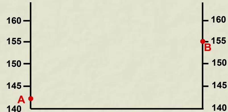
Ближайшая к точке А горизонталь по линии профиля имеет высоту 145 м. Расстояние до нее 3 мм. Таким образом становятся известны координаты следующей точки линии профиля. Она имеет высоту 145 м и находится на расстоянии 6 мм от левой вертикальной оси.
