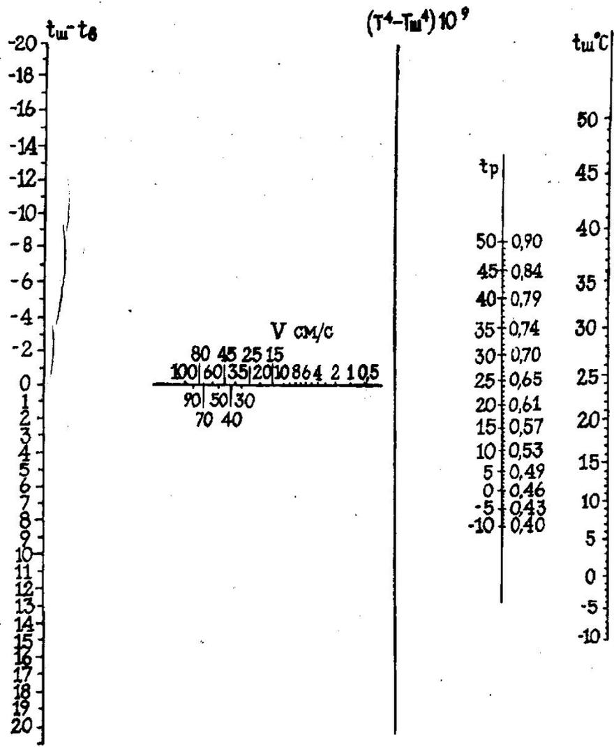
Допустим, что температура шарового термометра ( $t_{\text{ш}}$ ) равна  $25^\circ$ , температура воздуха ( $t_{\text{в}}$ )  $=20^\circ$ ,  $V=0,1$  м/с (10 см/с). Найти среднюю радиационную температуру  $t_p$ .
