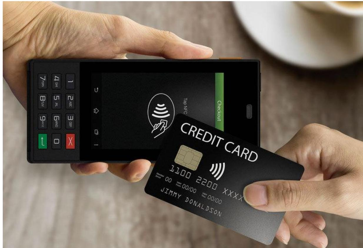
**NFC (Near Field Communication)** – технология беспроводной передачи данных малого радиуса действия, для обмена данными между устройствами, находящимися на расстоянии около 10 сантиметров
