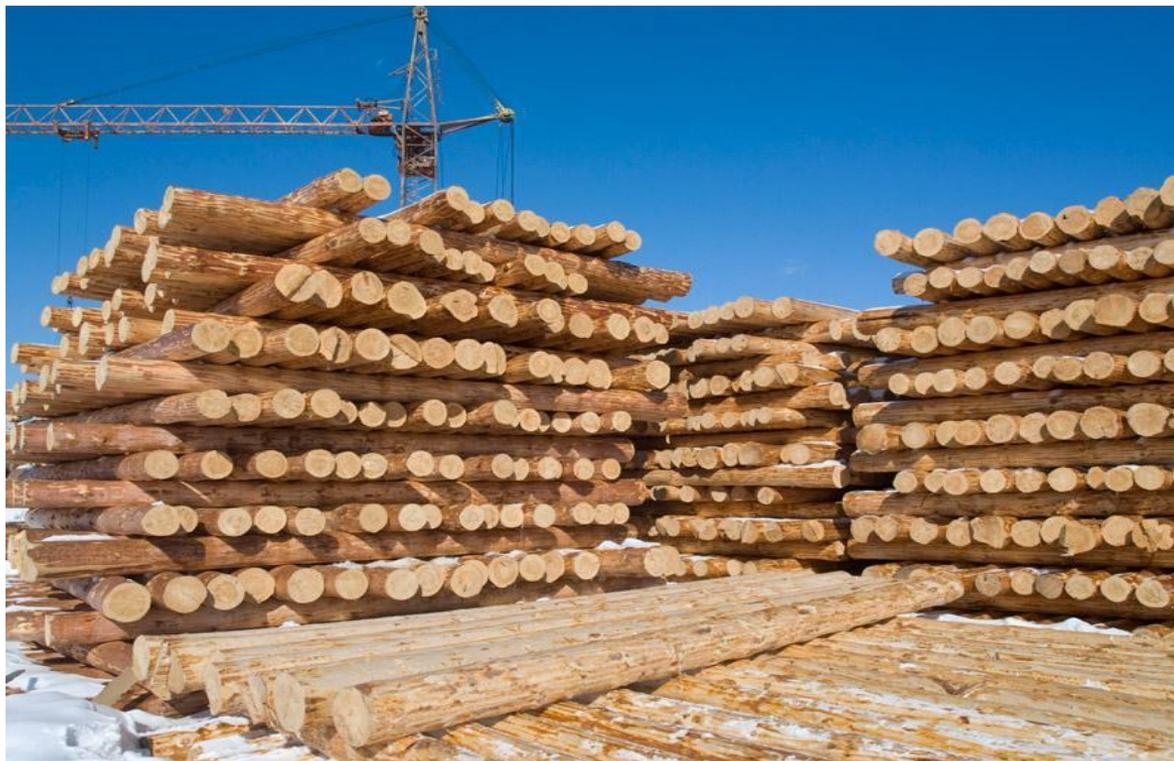
**Для создания благоприятных условий для сушки древесины, лесоматериалы укладывают небольшими штабелями в 2-3 ряда, уделяя особое внимание защите нижнего ряда. Для предотвращения его порчи укладку производят на окоренные подкладки. Именно от их высоты (35-40 см) зависит степень сохранности древесины. Помимо этого под нижним штабелем не должно быть травы. Несоблюдение правил может повлечь поражение самих подкладок.**
