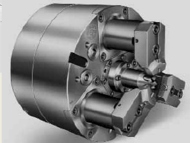
Прижимной механизированный патрон
