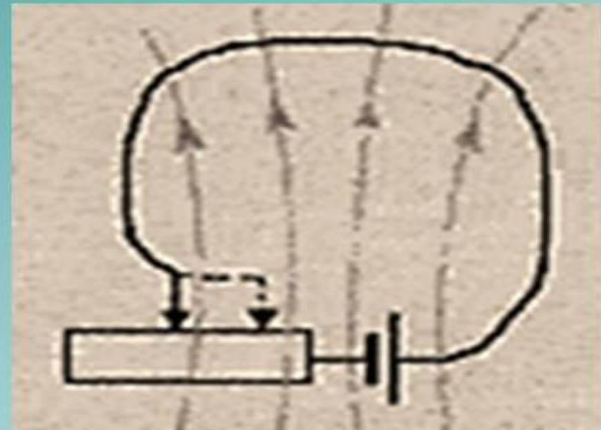
**САМОИНДУКЦИЯ – возникновение вихревого электрического поля в проводящем контуре при изменении силы тока в нем; частный случай электромагнитной индукции.**
