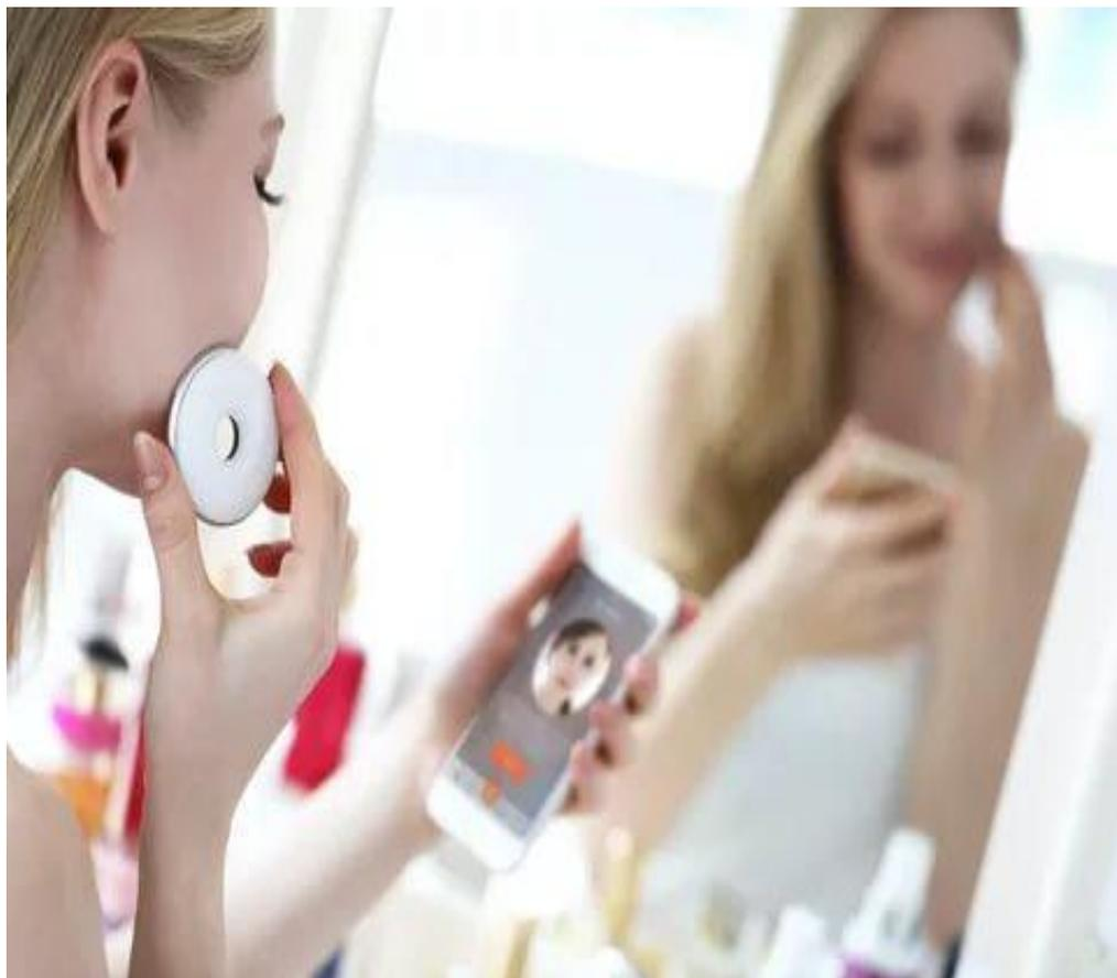
Wayskin Skin Analyzer — устройство с датчиком, который измеряет уровень увлажнения кожи, а также влажность окружающей среды и индекс ультрафиолета, собирает все данные, соединяется с мобильным устройством через Bluetooth, где и выдает информацию в специальном приложении.
